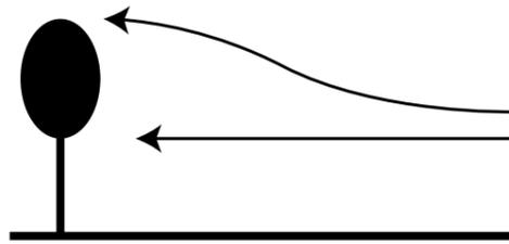
Figura 40. Direccionamiento del viento por vegetación
