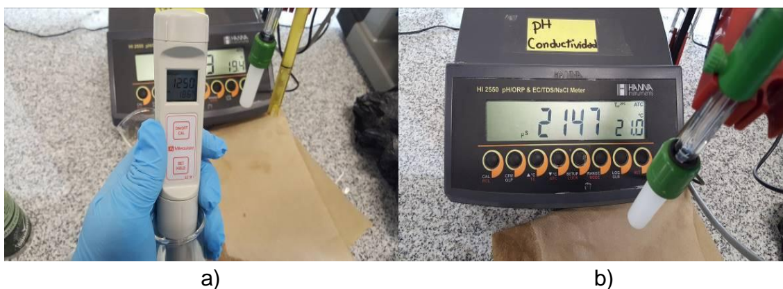
Figura 42. Fotografías calibración de medidores de CE:
