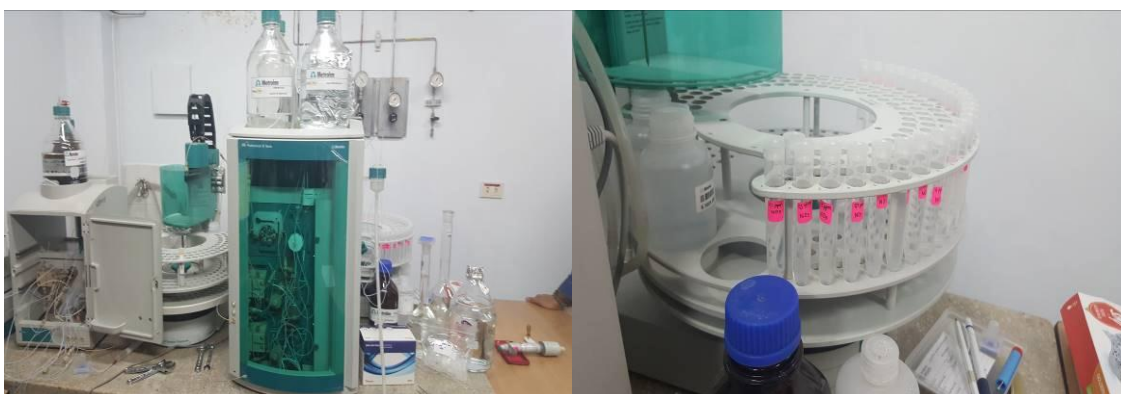
Figura 31. Fotografías sistema medidor por cromatografía iónica:
