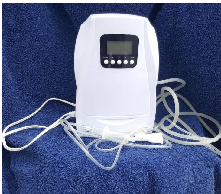
Figura 13. Fotografía equipo generador de ozono
