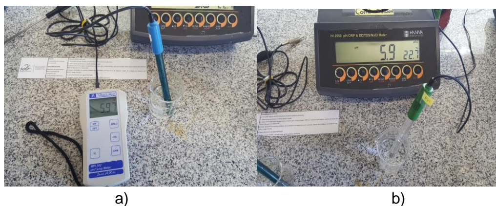
Figura 40. Fotografías calibración de equipos medidores de pH:
