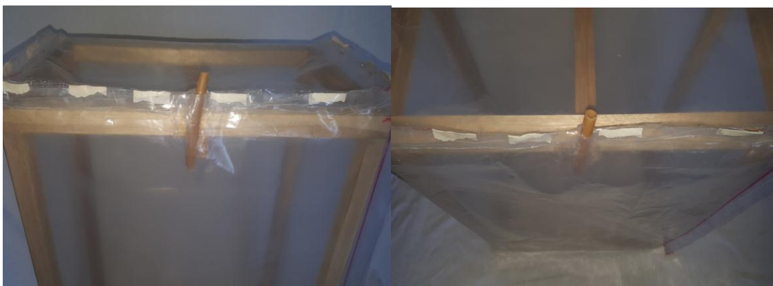
Figura 12. Fotografías de las mangueras utilizados para el ingreso del gas:
