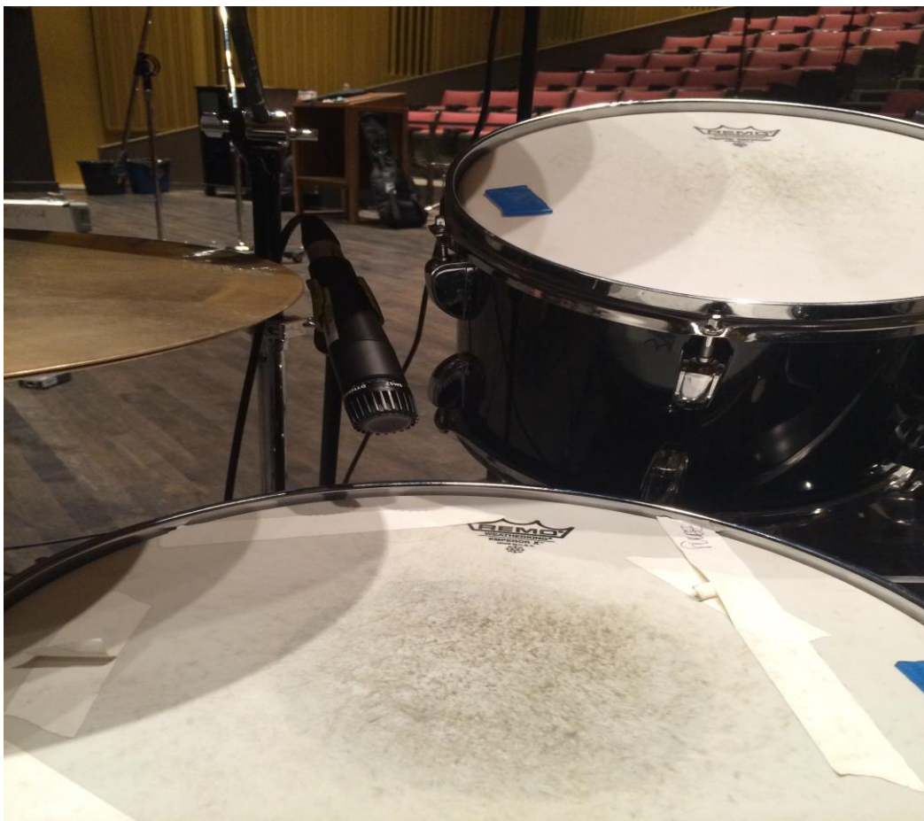
Figura #8.- Técnica de microfonía para la caja. Tomado de Absolut Records S.A.
