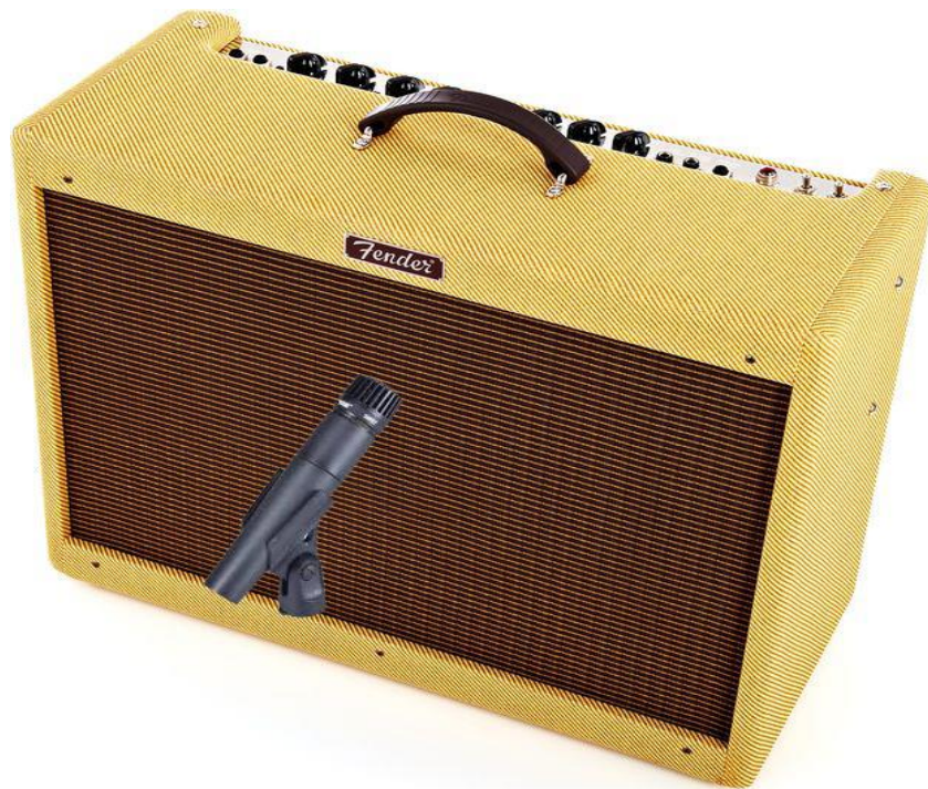
Figura #13.- Técnica de microfonía para amplificador Fender Blues Deluxe con Shure SM57. Adaptado de fender.com y shure.com
