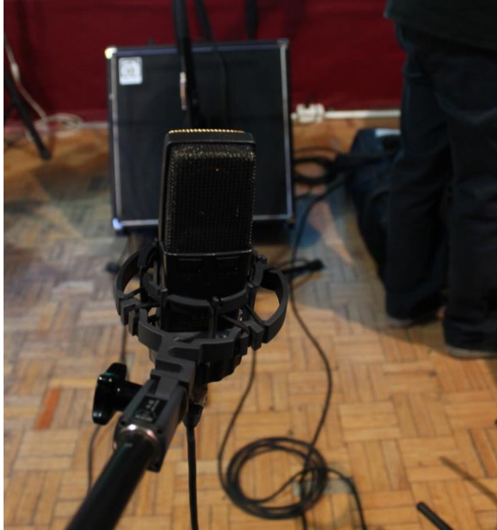
Figura 19: Micrófono AKG C414 ubicado a metro y medio del amplificador.
