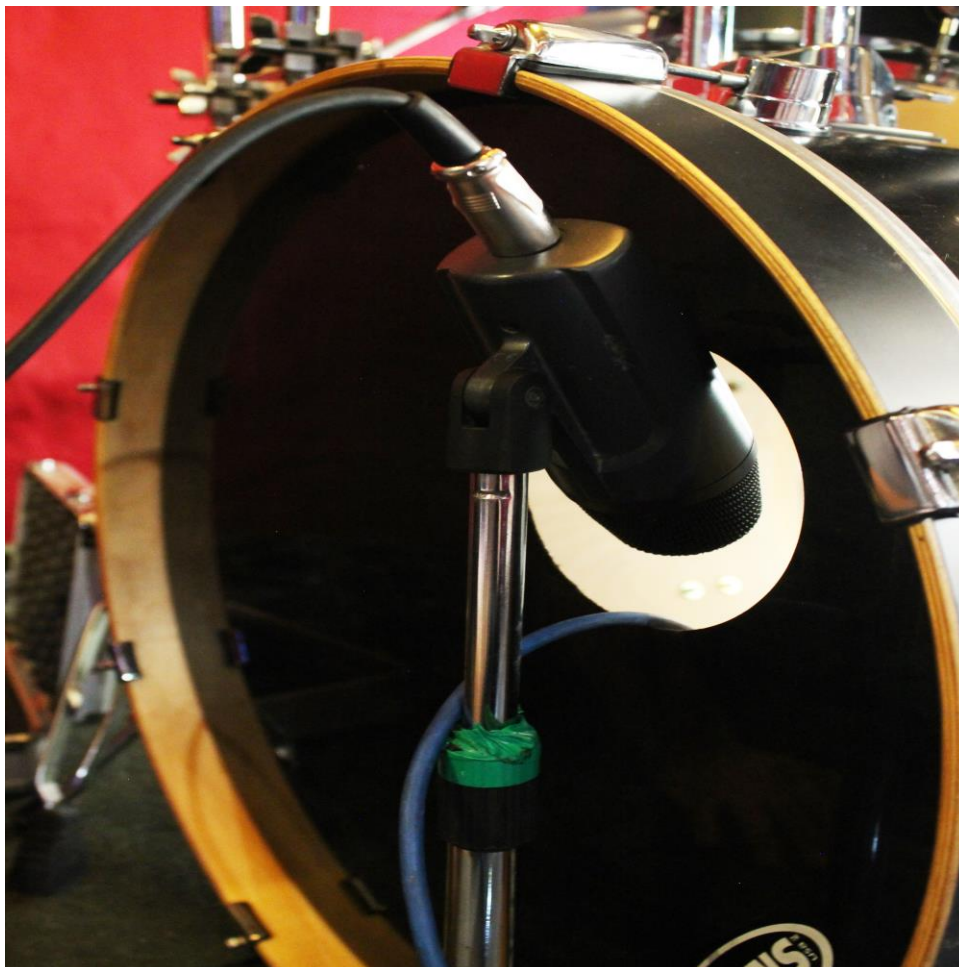
Figura 4: Micrófono Sennheiser e602 posicionado en la membrana del bombo.
