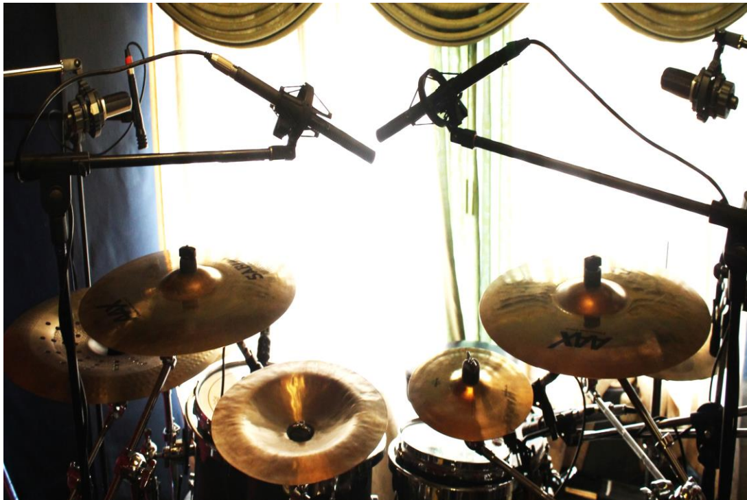
Figura 13: Micrófonos AT 897 y AKG C212 grabando ambientes en técnica XY y AB respectivamente.
