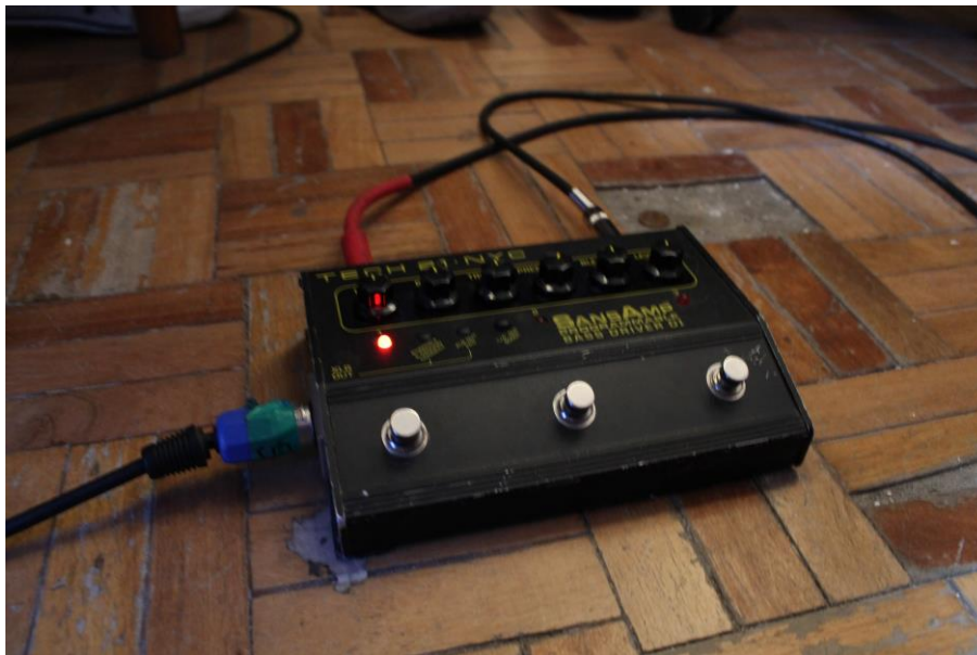
Figura 21: Pedal de distorsión para bajo con salida directa Sans Amp.
