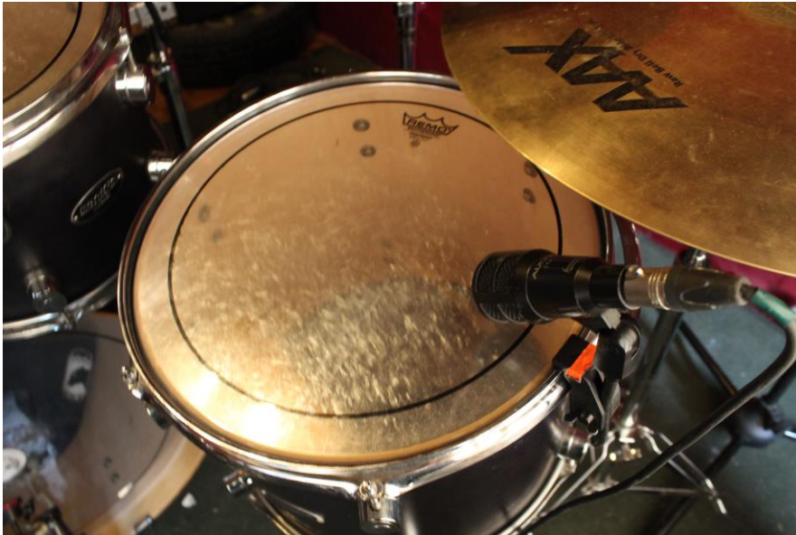
Figura 9: Micrófono Audix F12 en parte la superior del tom de piso.
