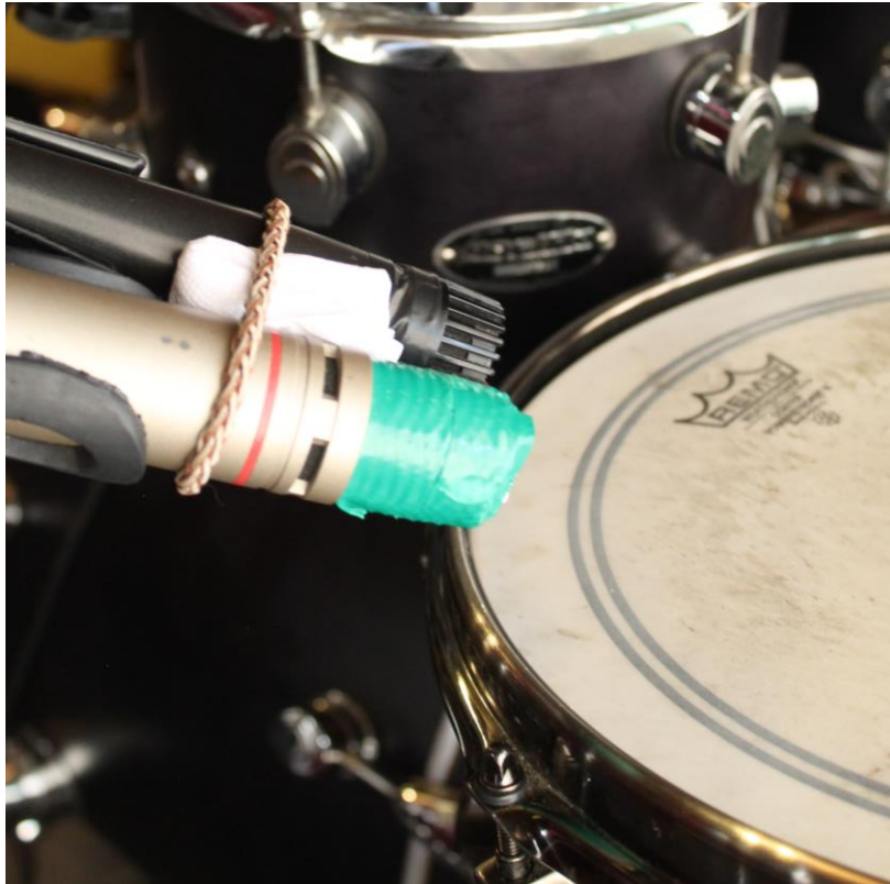
Figura 5: Micrófonos Shure y AKG apuntando al centro del redoblante.
