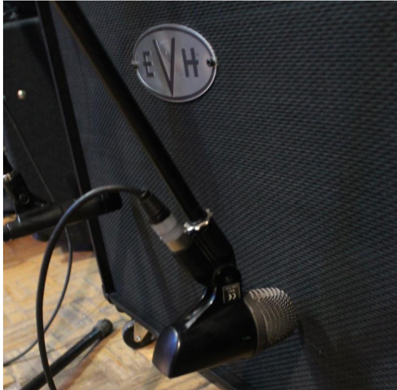
Figura 23: Micrófono AKG D112 apuntando al cono del amplificador.
