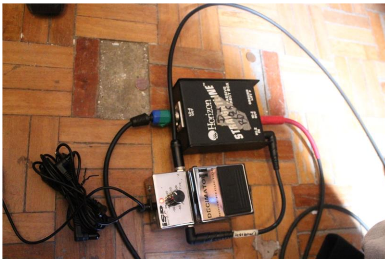
Figura 27: Pedal supresor de ruido y caja directa.
