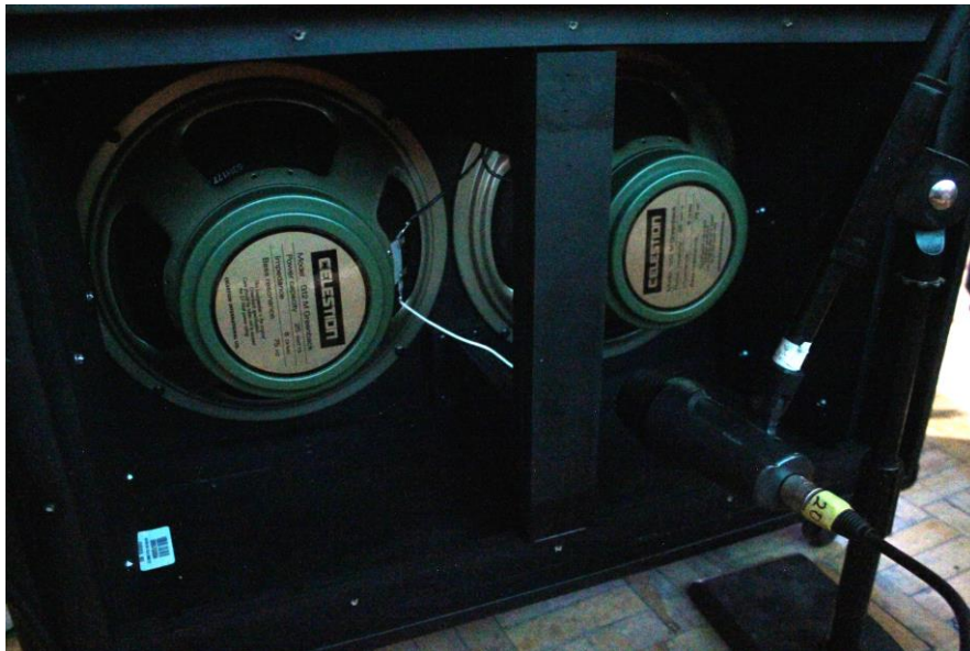
Figura 22: Micrófono Sennheiser e602 ubicado en la parte posterior del amplificador.
