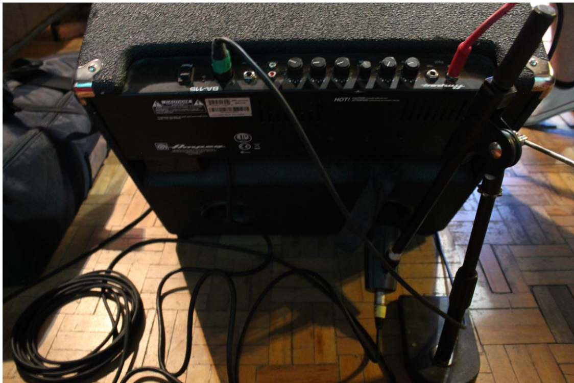
Figura 20: Línea Directa del Amplificador y micrófono AKG D12.
