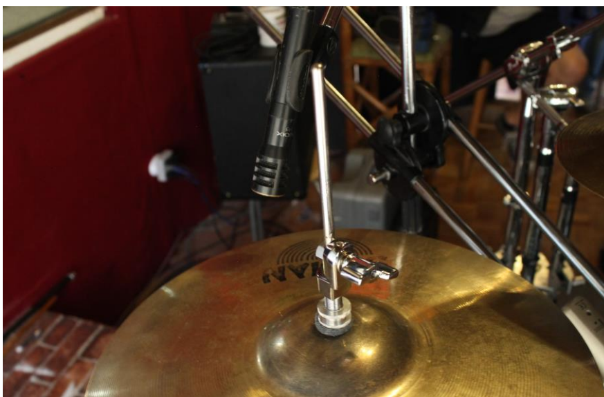
Figura 11: Micrófono Audix F15 captando al hihat.
