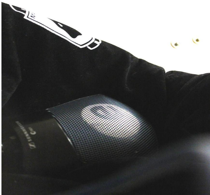
Figura 3: Micrófono Sennheiser e901 posicionado adentro del bombo.
