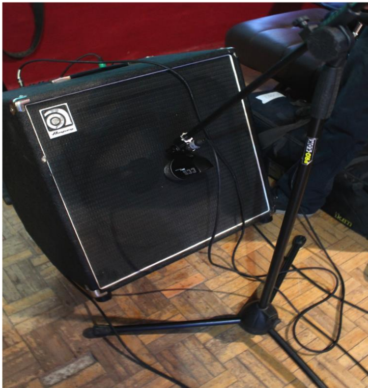
Figura 18: Micrófono Sennheiser e602 en centro del cono del amplificador.
