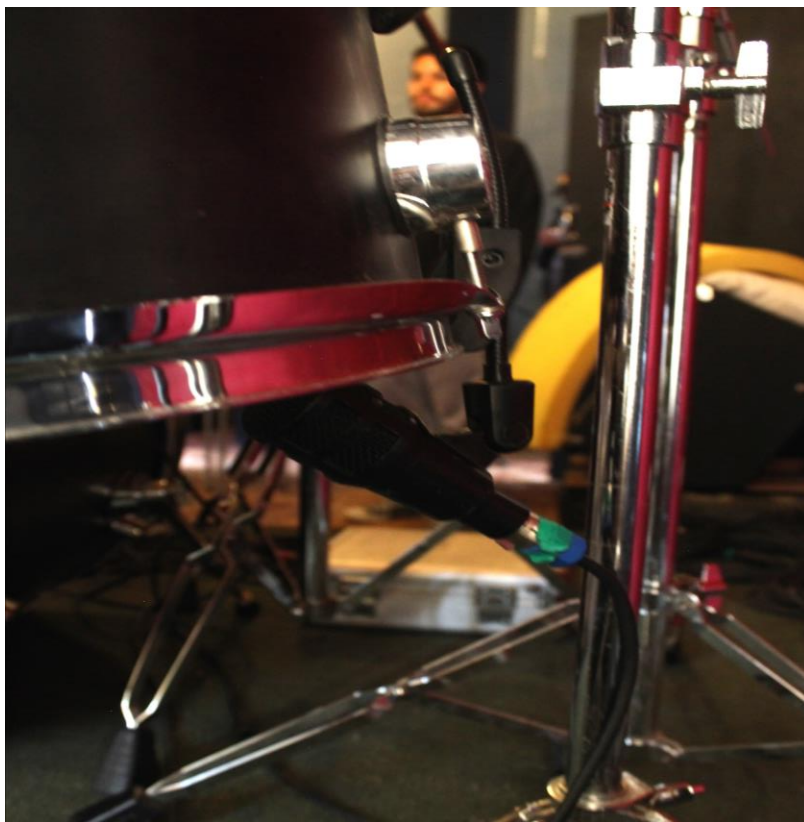
Figura 10: Micrófono Audix F12 en la parte inferior del tom de piso.
