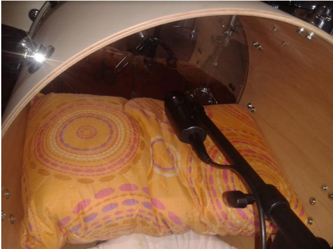
Figura 11: Micrófono Sennheiser e602 utilizando en el bombo.
