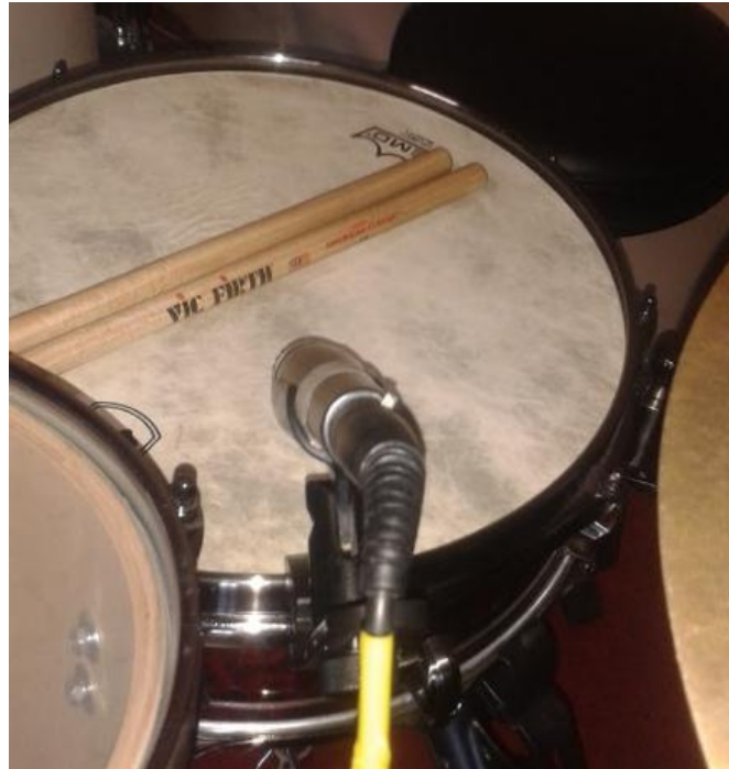
Figura 12: Micrófono Shure SM57 utilizando en el parche superior de la caja.
