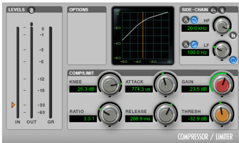
Figura 45: Compresor con ajustes para el canal de efectos de voz.
