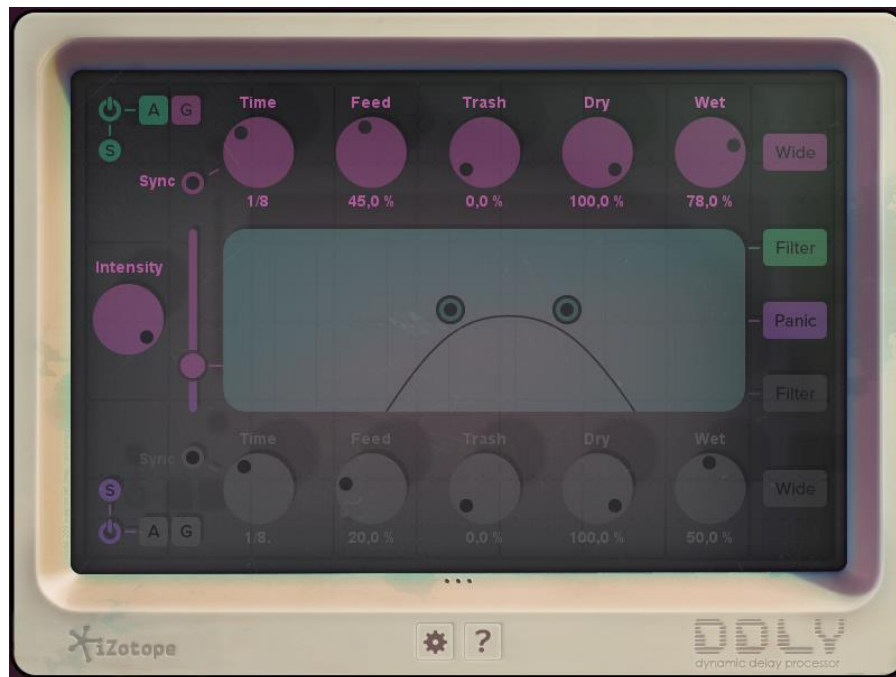
Figura 46: Delay con ajustes para el canal de efectos de voz.
