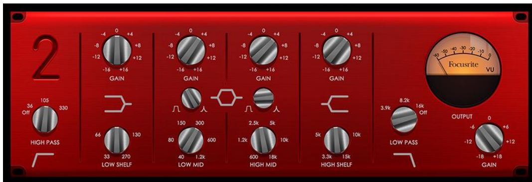
Figura 44: EQ con ajustes para el canal de efectos de voz.
