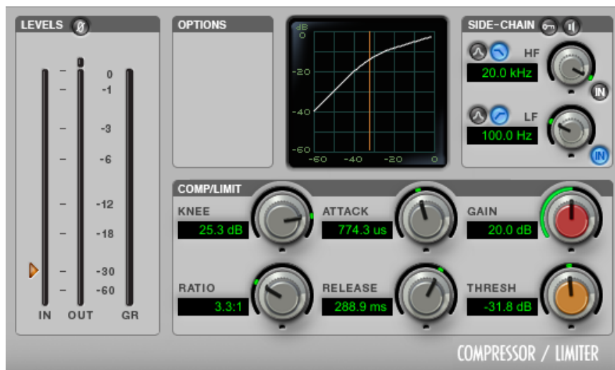
Figura 41: Compresor con ajustes para el canal la voz principal.
