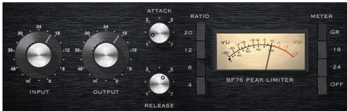
Figura 25: Compresor con ajustes para el canal bombo in.
