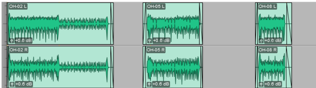
Figura 18: Limpieza y cortes aplicados a las pistas de los overheads y room.
