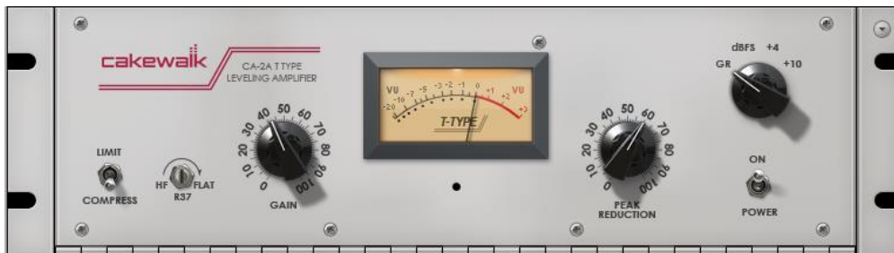
Figura 34: Compresor con ajustes para el canal de los overheads.
