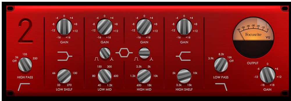
Figura 32: EQ con ajustes para el canal de los toms.
