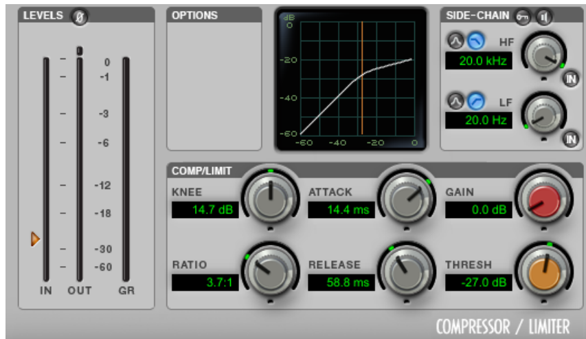
Figura 28: Compresor con ajustes para el canal snare up.
