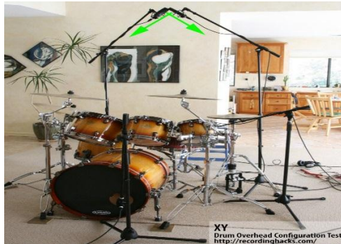
Figura 25. Técnica X-Y aplicada en un kit de batería.
