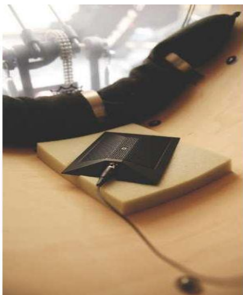
Figura 18. Microfoneo al interior del bombo usando beta 91.
