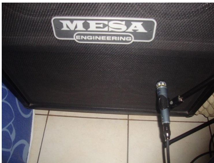
Figura 73. Microfoneo de cabinet con Beta58
