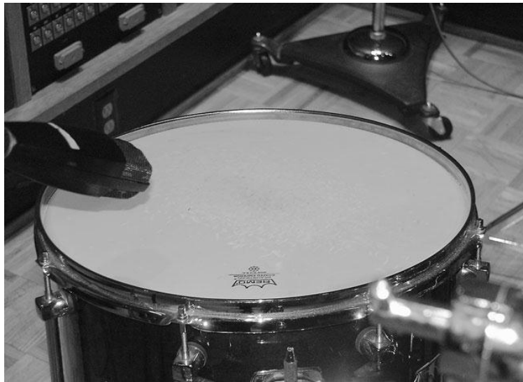
Figura 19. Posicionamiento de micrófono MD421 en Toms Tomado de Owsinski (2005, pag.138)
