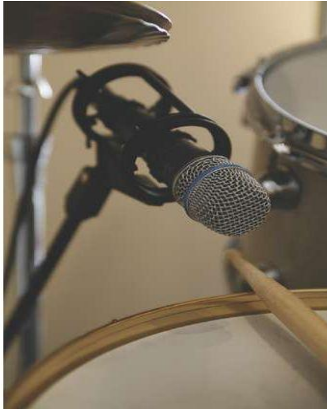
Figura 14. Microfoneo de caja con shure beta57a Tomado de Riley, 2009
