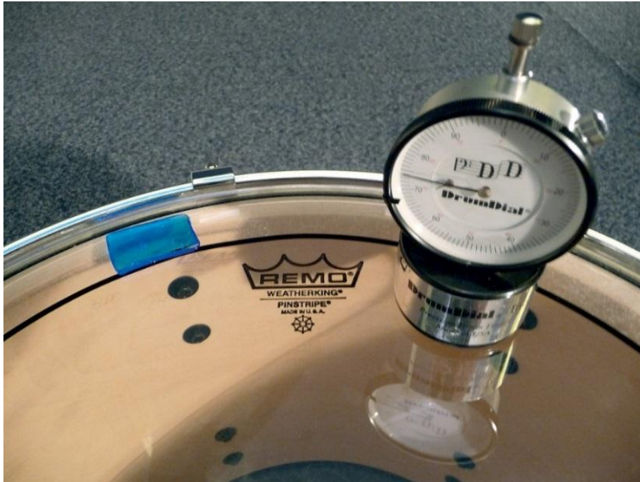
Figura 3. Drum Dial para afinar baterías
