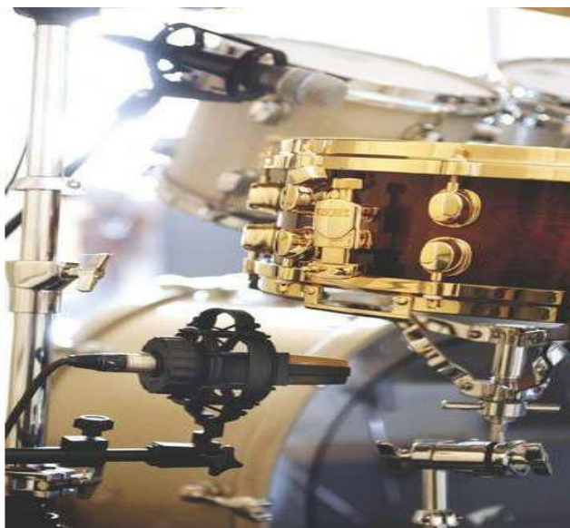
Figura 16. Microfoneo de snare top y bottom Tomado de Riley, 2009
