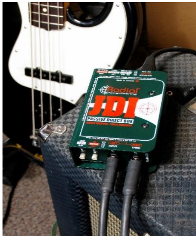
Figura 33. Bajo conectado a una Caja directa JDI
