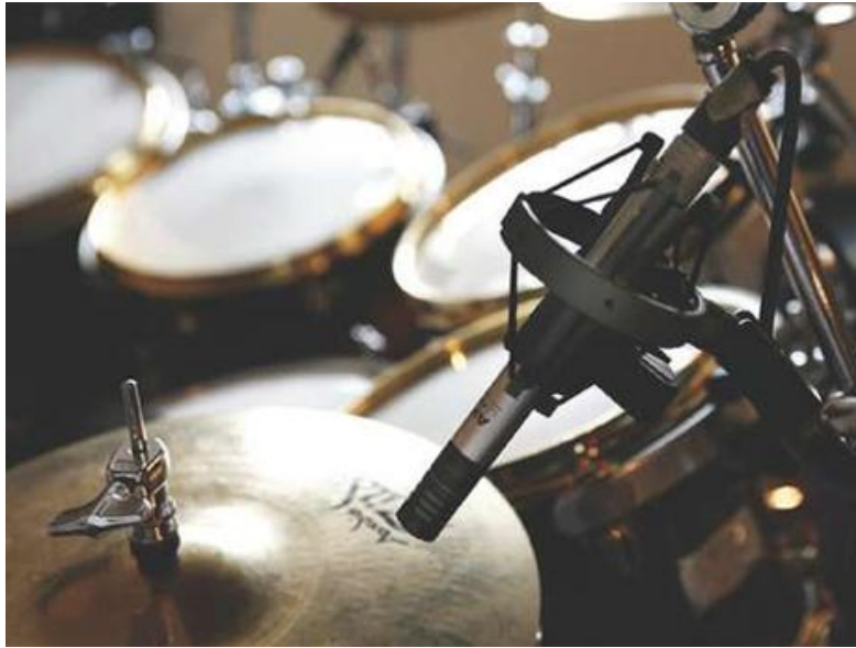
Figura 20. Microfoneo de rid usando condensador de diafragma pequeño. Tomado de Riley, 2009
