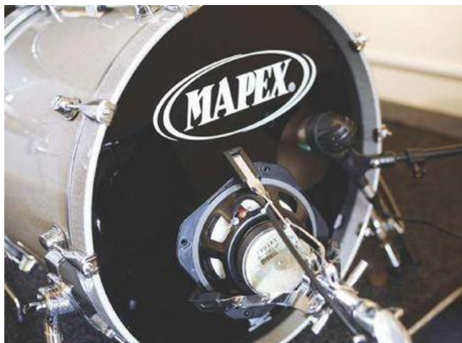
Figura 17. Microfoneo de bombo usando dos micrófonos.
