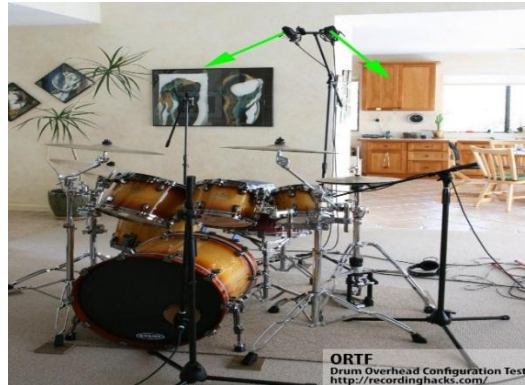
Figura 23. Técnica ORTF aplicada en un kit de batería.
