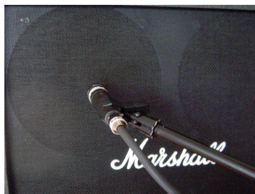
Figura 38. Microfoneo de cabinet usando un SM57 en el centro del cono
