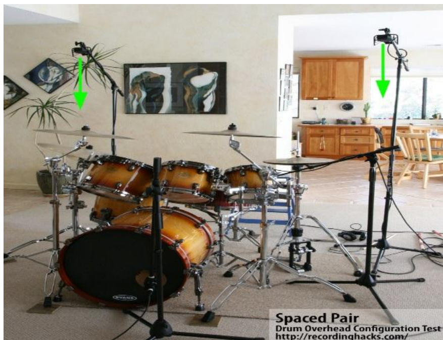
Figura 27. Técnica de Par espaciado aplicada en un kit de batería.
