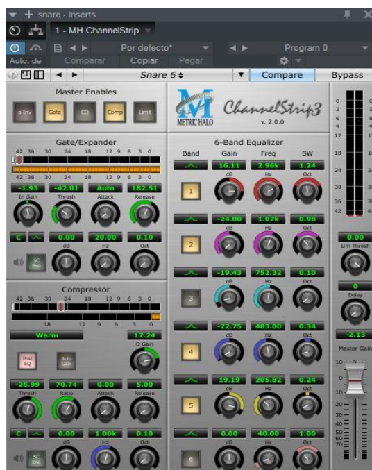
Figura 120. Channel strip para snare bus
