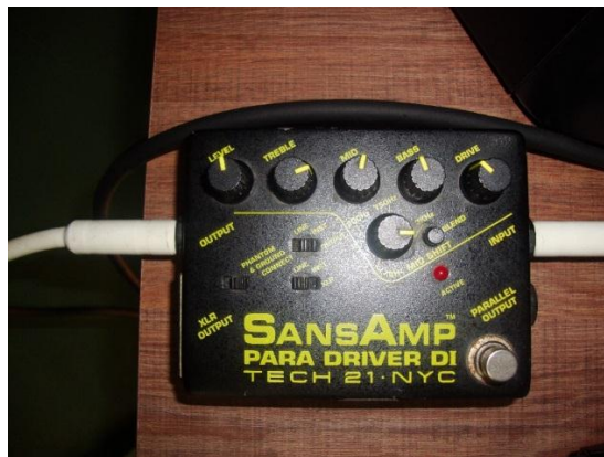
Figura 57. Stomp box SansAmp para driver DI
