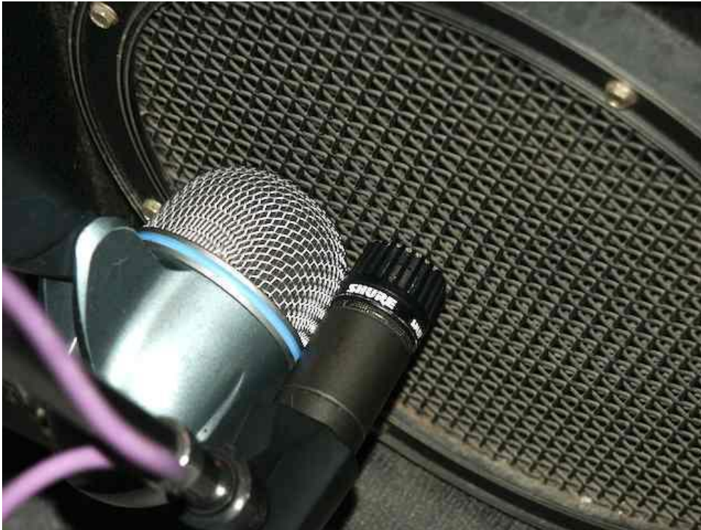
Figura 35. Microfoneo de cabinet de bajo usando dos micrófonos dinámicos.
