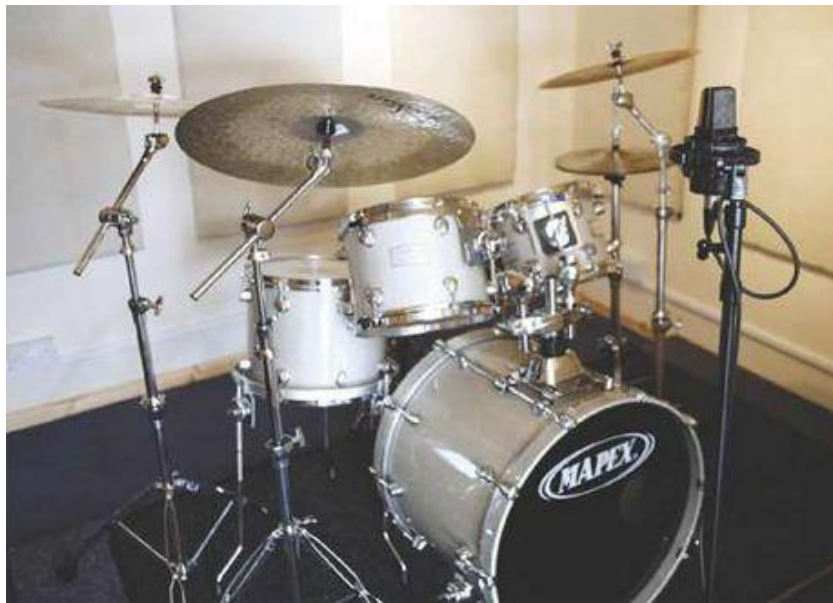
Figura 28. Microfoneo de Room usando un condensador de diafragma grande. Tomado de Riley, 2009
