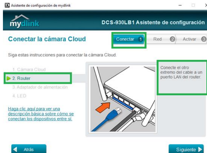
Figura 149. Conexión de cámara al router.
