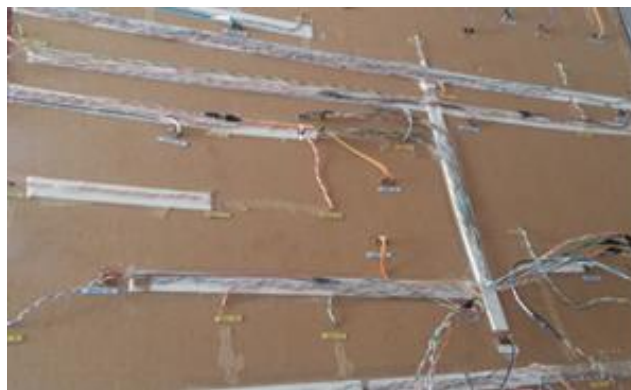
Figura 55. Cableado y etiquetado sobre la maqueta.
