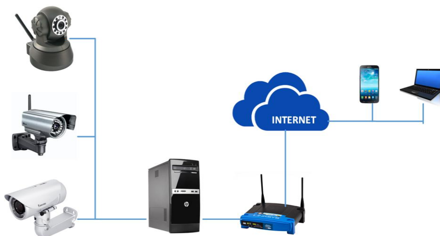
Figura 27. Esquema de video vigilancia IP. Tomado de Rodych Seguridad esquema de vigilancia (2014).
