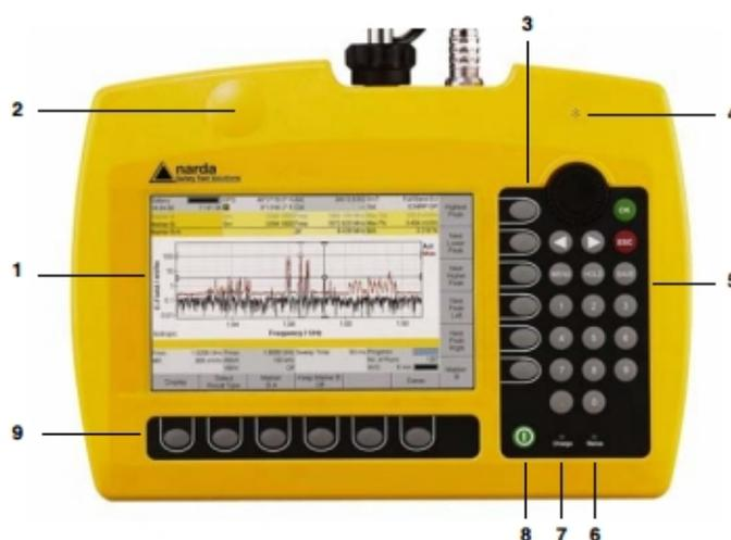
**Figura 23.** Partes Principales de Narda SRM-3600
