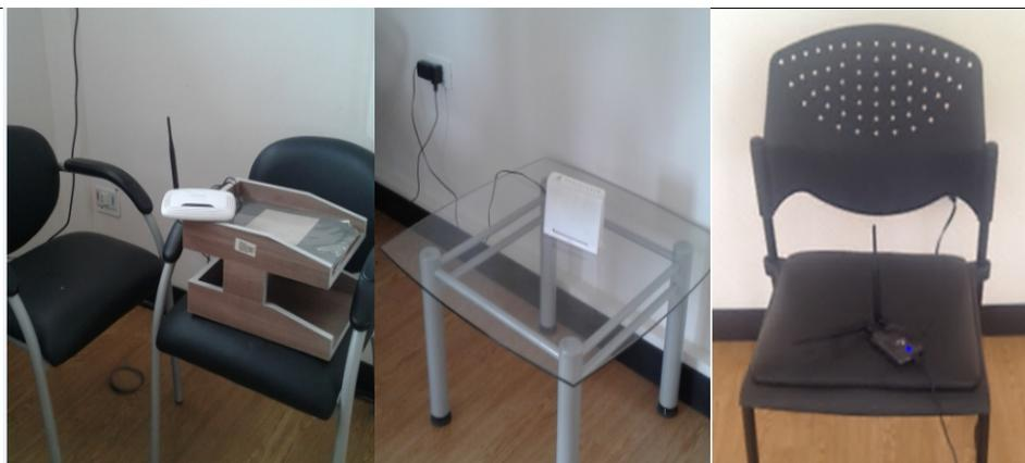
*Figura 53.* Equipos de medición Router Inalámbrico Tp-link, Modem Huawei Hg532 y Adaptador SL3504N operando en la banda WiFi – San Juan de Calderón –Quito.
