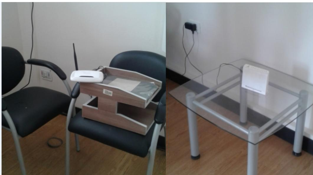
Figura 45. Equipos de Medición Router Inalámbrico Tp-link y Modem Huawei Hg532 - Opera en la banda WiFi – San Juan de Calderón – Quito.
