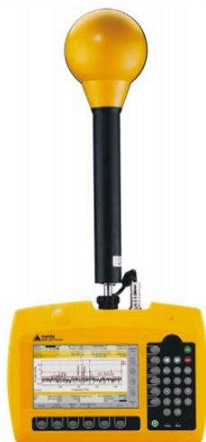
*Figura 22. Medidor de Emisión Selectiva Narda SRM-3600.
