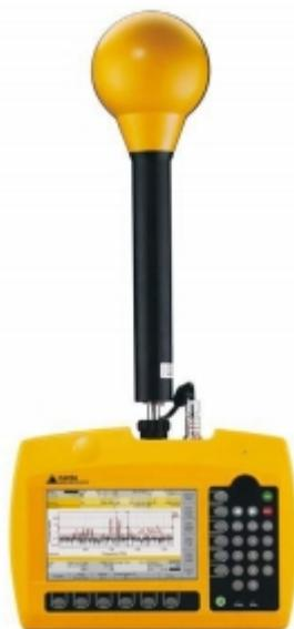
*Figura 7. Medidor de Emisión Selectiva Narda SRM-360.*
