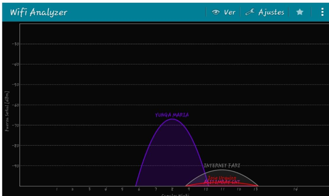
Figura 103. Ocupación del Canal en la banda WiFi – 1 equipo – Hogar Sur - Software WiFi Analyzer.
