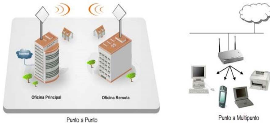
Figura 13. Conexión punto a punto y punto multipunto. Adaptado de: (CISCO, 2014)
