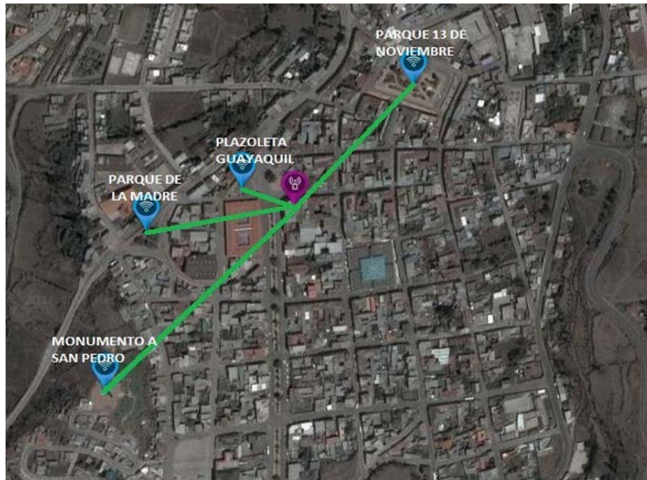
Figura 32. Diagrama de enlaces punto a punto en el GAD Alausí. Adaptado de: (GAD ALAUSI, 2015)
