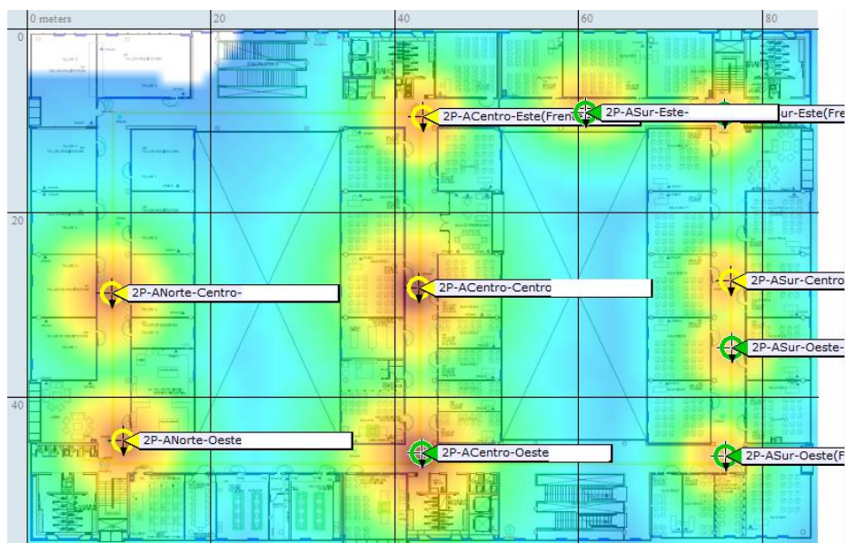
Figura 38. Cobertura antenas granados P2 (2,4MHz)
