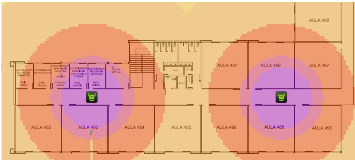
Figura 54. Cobertura antenas Queri Bloque 4- Planta alta (2,4MHz)
