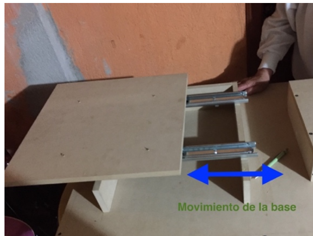
Figura 31. Base para la estructura del edificio.
