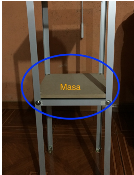
Figura 28. Colocación de la masa en el primer piso.
