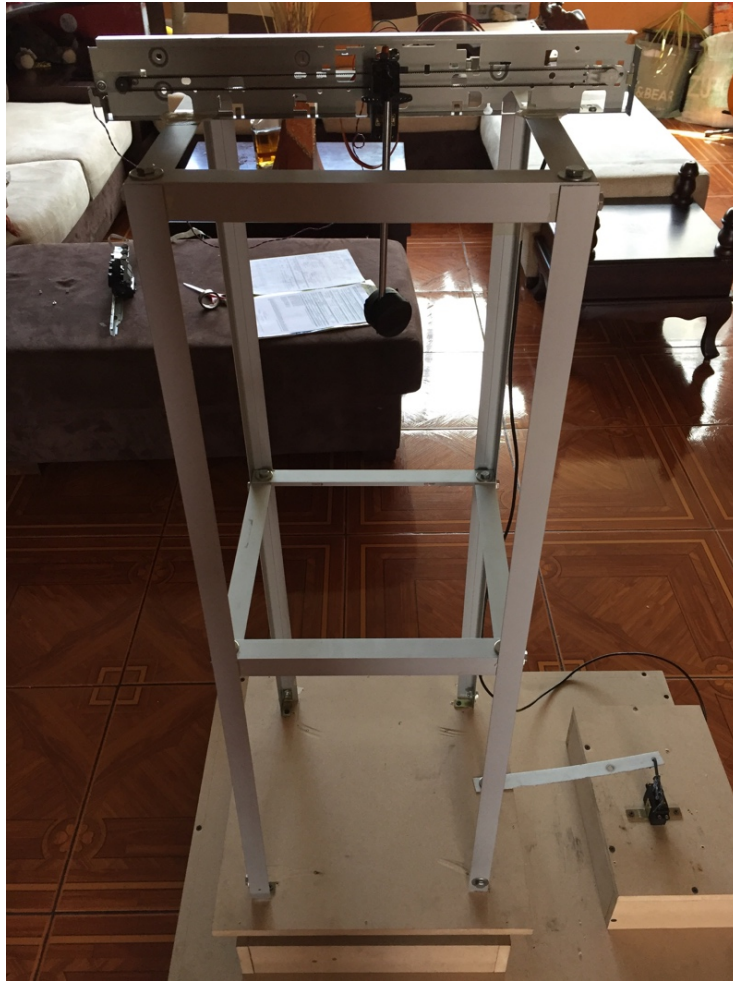
Figura 37. Controlador PID sobre la estructura del edificio.
