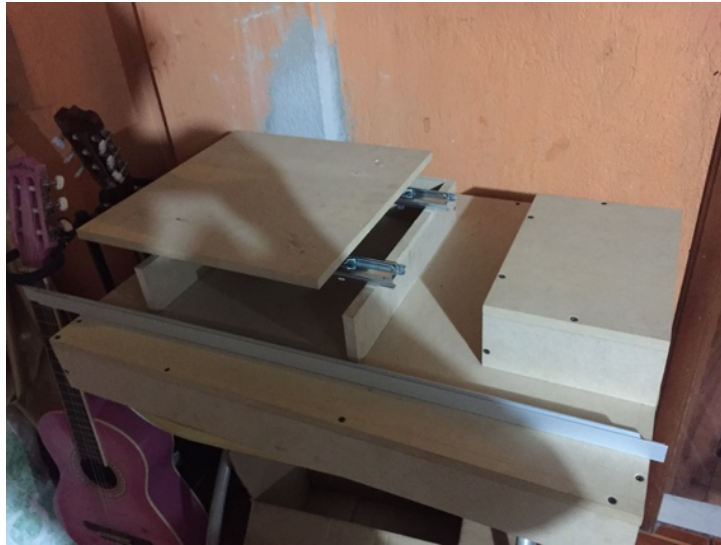
Figura 33. Base para el control de la mesa vibratoria.
