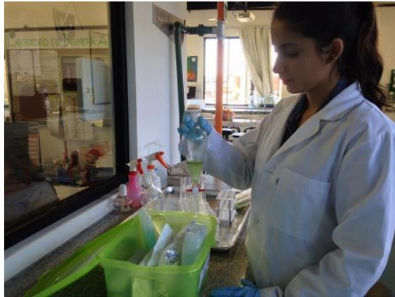
Anexo 2. Extracción de compuestos bioactivos: Separación de fases con ayuda de refrigerantes.
