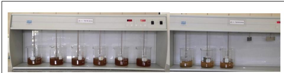
Anexo 3. Tratamiento de Aguas Residuales: Proceso de Coagulación – Floculación.
