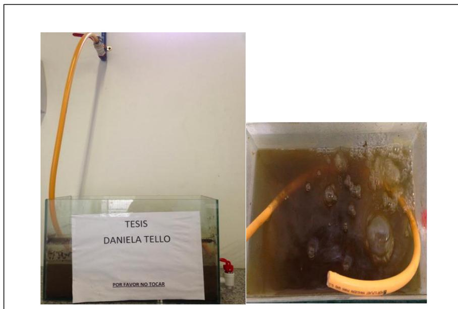
Figura 9. Biorreactor de aireación prolongada
