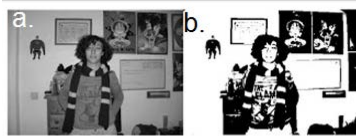
Figura 23. Conversión de imagen escala grises a imagen binarizada.
