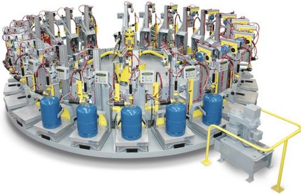
Figura 1: Proceso automatizado de llenado de botellas.
