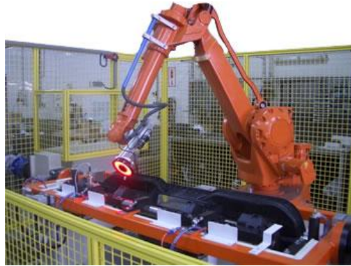
Figura 28. Brazo robótico utilizado para el control de la calidad.
