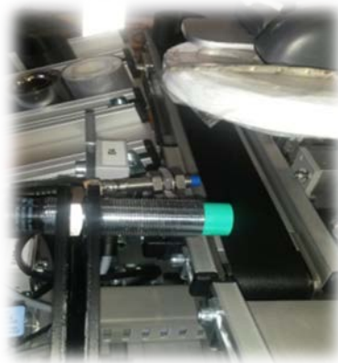
Figura 60. Sensor de movimiento usado en módulo flexible.
