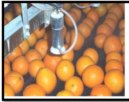
Figura 30. Sistema de adquisición de imágenes y tratamiento difusor de cera.
