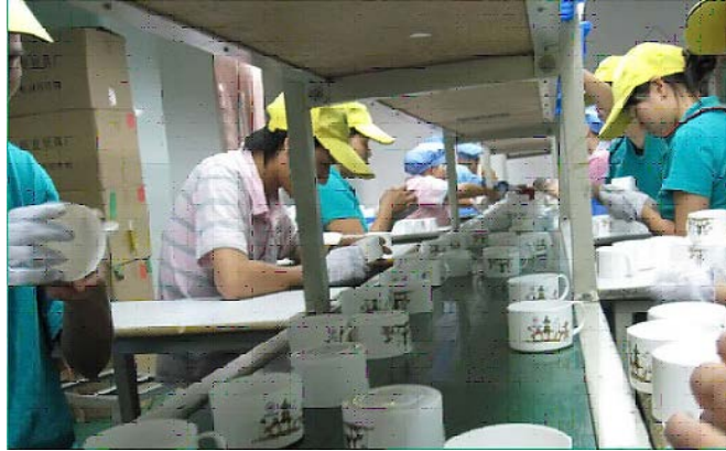
Figura 7. Verificación del control de la calidad en tazas.
