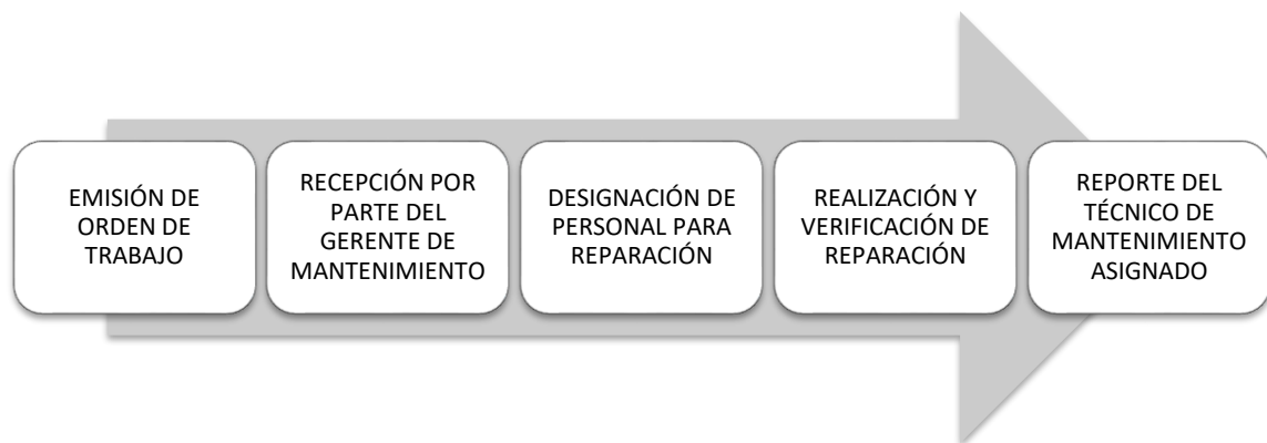
Figura 5. Procedimiento de emisión de órdenes de trabajo Tomado de (Manuales y Procedimientos del grupo ACCOR, s.f)
