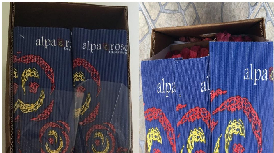
Figura 16. Vista interna de caja, antes y después de ensayos de caída
