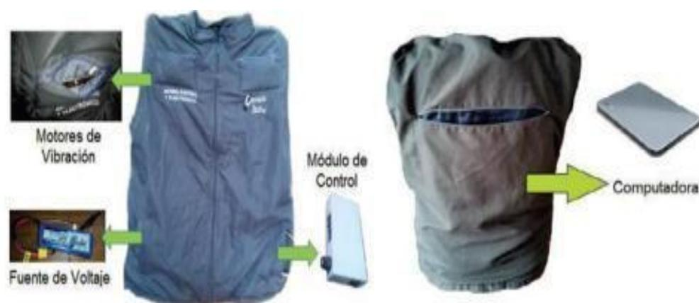
Figura 3. 17 Adaptación del sistema de vibración del chaleco.
