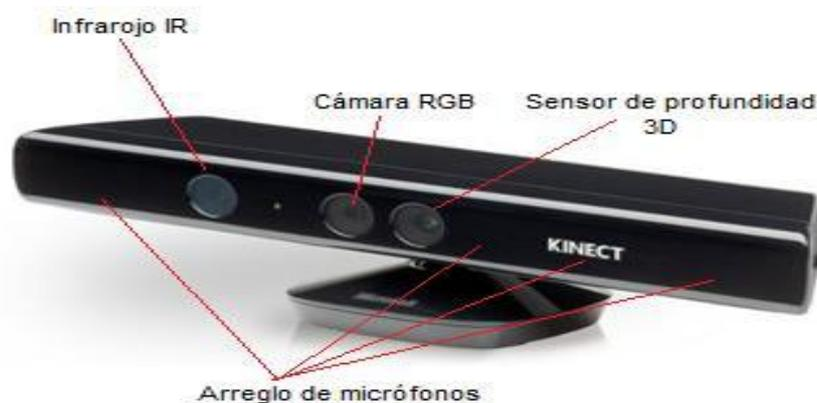
Figura 1. 9 Componentes de Kinect para Windows.
