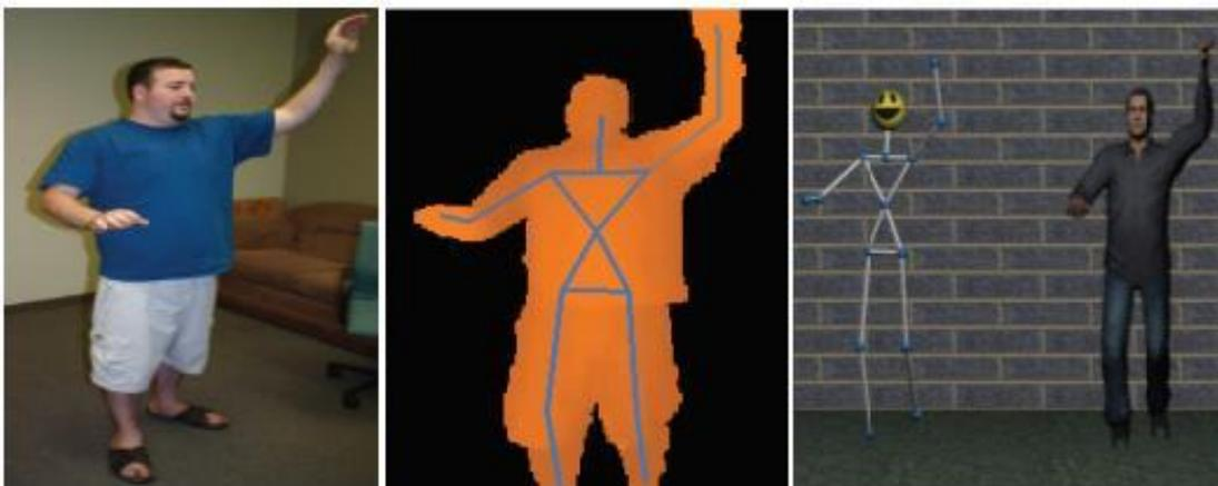
Figura 4.4 Identificación y segmentación al usuario a partir de una imagen con PrimeSense.
