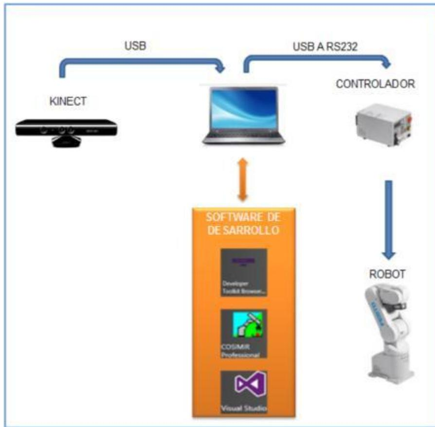
Figura 3. 27 Arquitectura del sistema mecatrónico.
