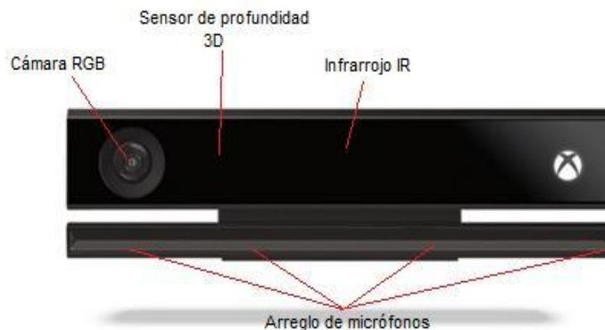
*Figura 1. 10 Componentes de Kinect 2.0.*
