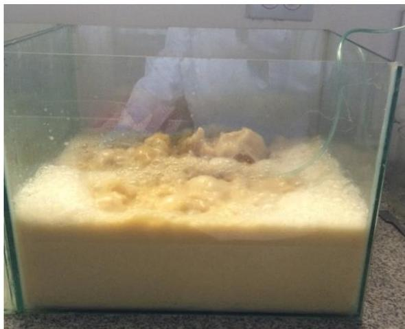
*Figura 6.* Flotación por aire disuelto.
