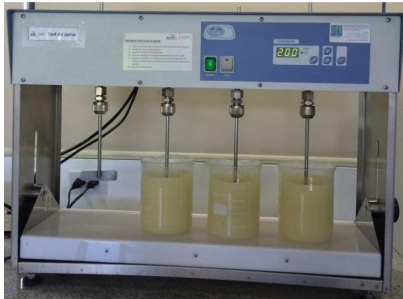
Figura 8. Equipo para el método test de jarras.
