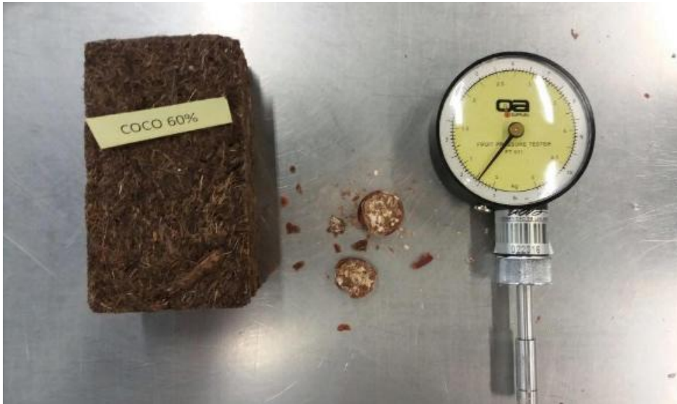
Anexo 5. Prueba de dureza en muestras
