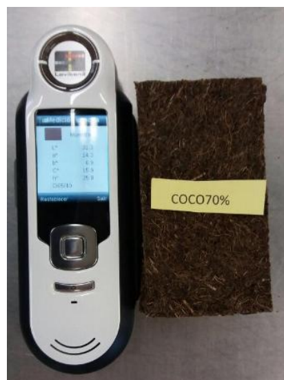
Anexo 6. Obtención de indicadores de las muestras con el colorímetro
