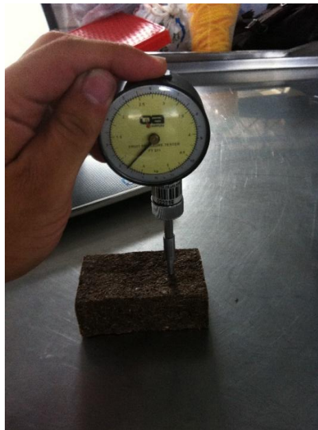
Anexo 2. Prueba de dureza de aglomerado
