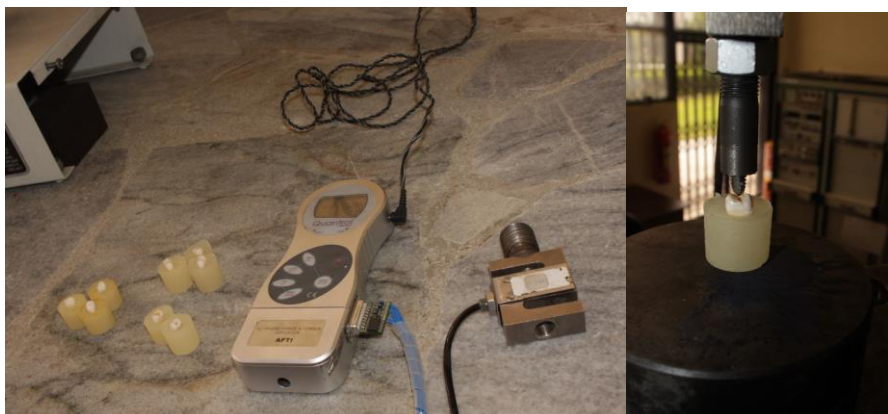
Figura 12. Prueba de carga mediante la utilización de una máquina de ensayo universal.
