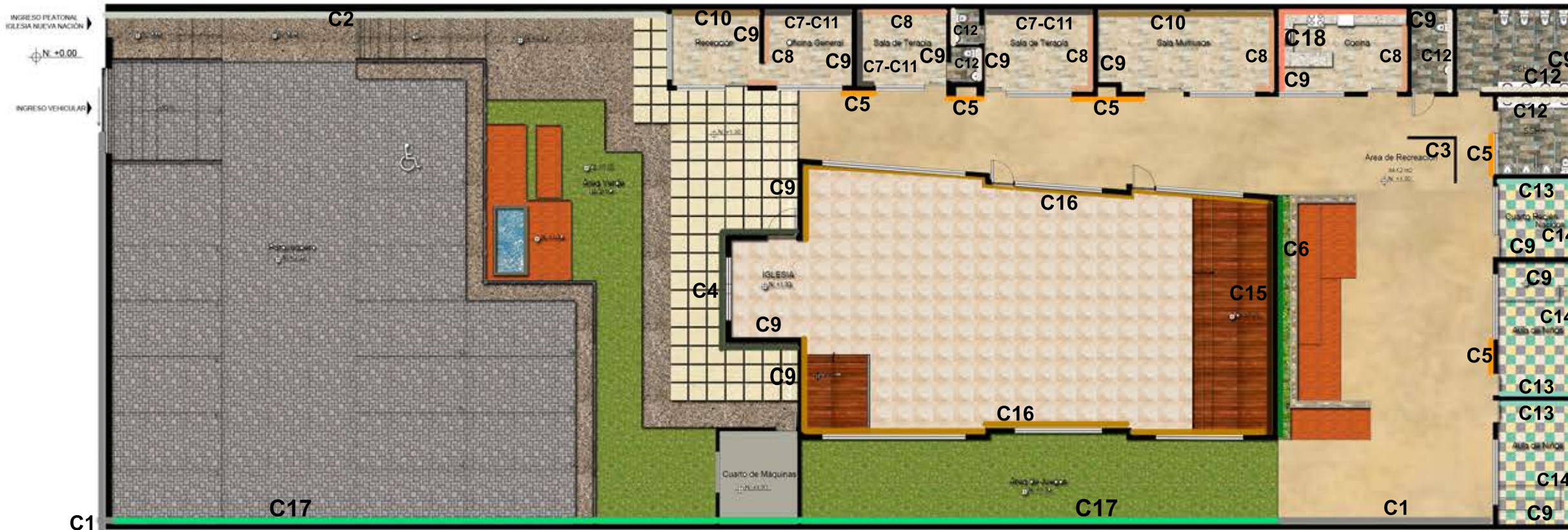
PLANO ACABADOS DE PAREDES ESC 1:200
