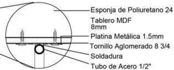
DETALLE 2 ESC 1:3 Anclaje Tubo Metálico con Tablero de MDF
