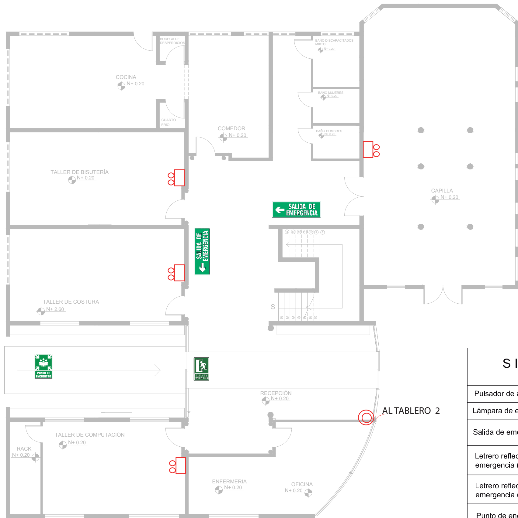
PLANTA BAJA INCENDIOS N.- +0.20 ESC.- 1:150
