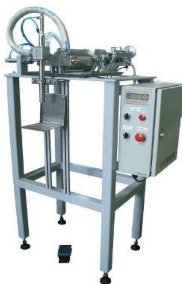
Fotografía No. III.12. Envasadora y selladora semiautomática a pistos
