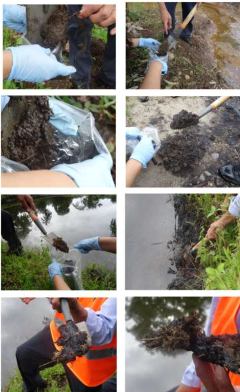
Figura 31. Imágenes de las muestras de suelos contaminados con hidrocarburos y crudo intemperizado.
