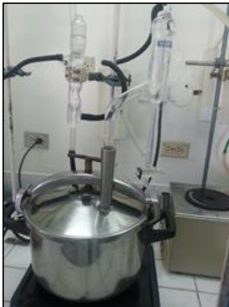
Anexo N° 1. Equipo destilación al vapor con trampa Clevenger
