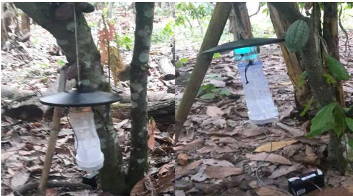
Figura 11. Trampa CDC de luz normal y trampa CDC de luz ultravioleta
