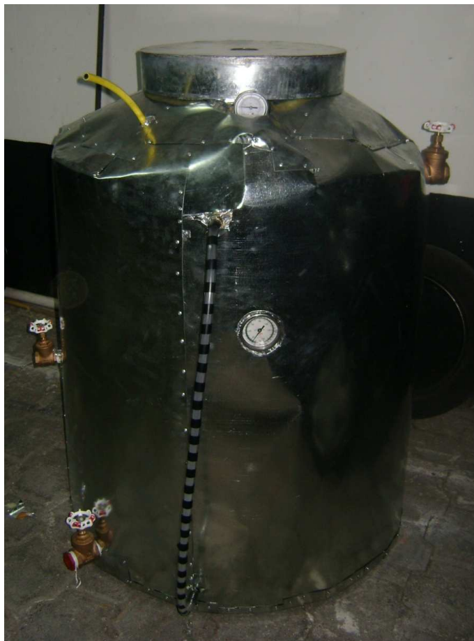
Fotografía N° 5.4: Bio-digestor terminado y listo para su instalación en campo
