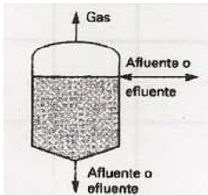
Gráfico N° 2.9: Diagrama de reactor de flujo ascendente-descendente
