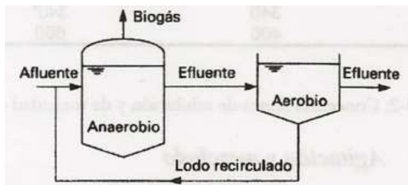
Gráfico N° 2.8: Diagrama de reactor de contacto anaerobio
