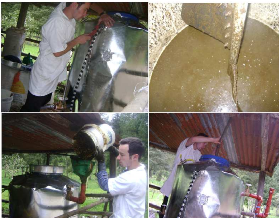
Fotografía N° 5.5: Reactor instalado en campo y arranque del mismo en la Hacienda San Juan
