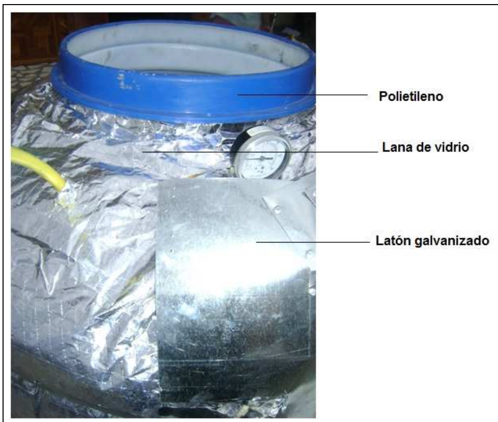
Fotografía N° 5.2: Estructura del tanque
