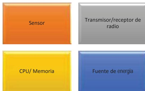
*Figura 15.* Estructura de los dispositivos de una red WSN
