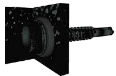
Anclaje de letreros de hierro en forja con ángulos de refuerzo y tornillos auto perforantes con arandela.
