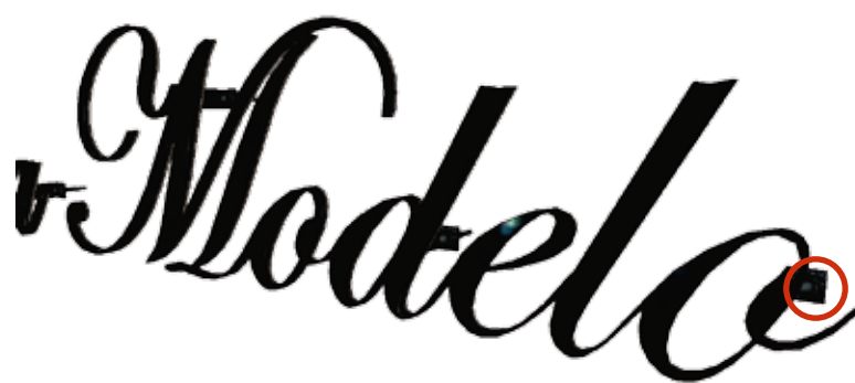
Señalética de hierro en forja e:18mm, Iluminación indirecta con cinta LED adhesiva / temperatura de color media / RA medio.
