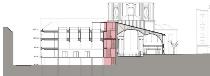
Figura 55. Sección resaltando las escaleras Tomado de (plataformaarquitectura, 2015)
