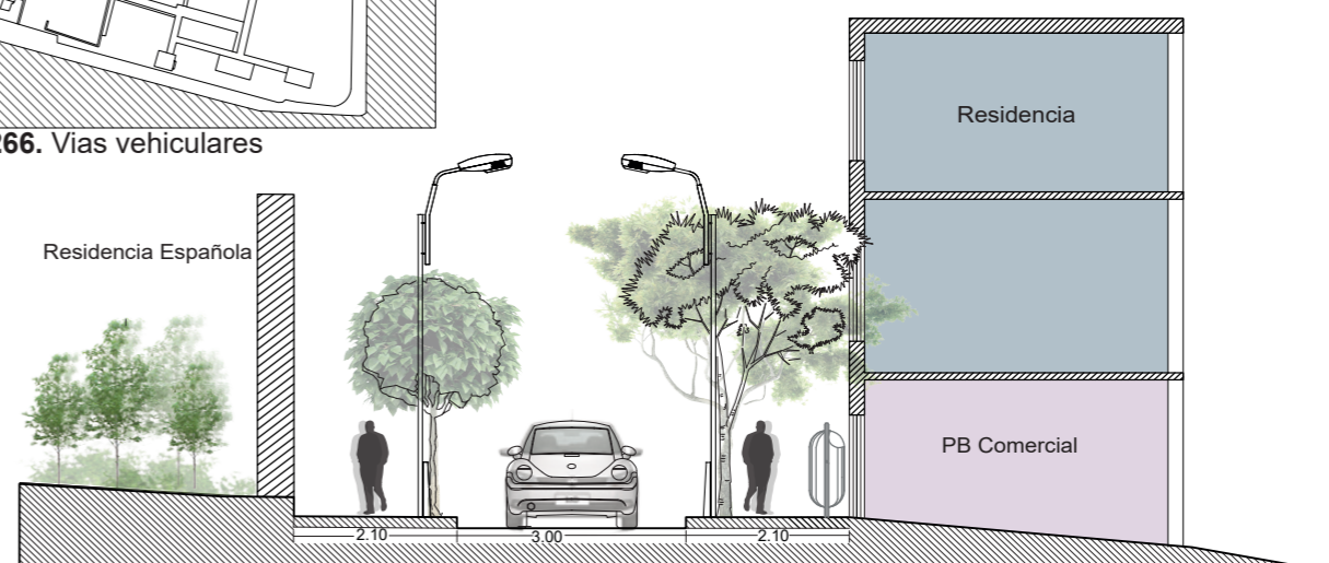
Figura 267. Corte vía vehicular, El Calvario
