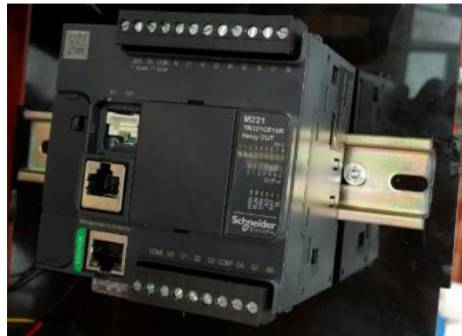
Figura 51. PLC anclado en riel DIN
