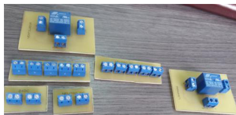
Figura 49. Diseño de Placas y Borneras
