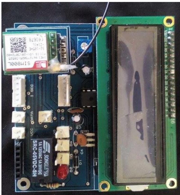
*Figura 39.* Placa del dispositivo diseñado con pantalla LCD y módulo SIM 800 conectados.
