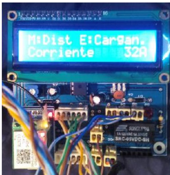
Figura 94. El vehículo está cargando con un nuevo valor el LED apagado indica la desactivación del relé.
