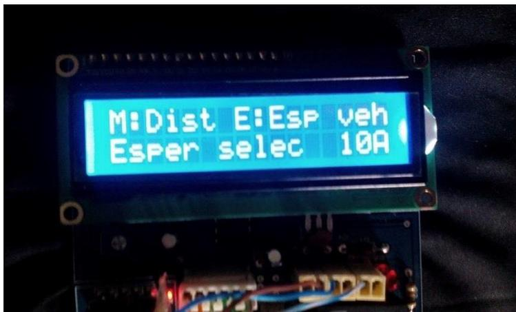
*Figura 52.* Dispositivo con el nuevo valor para la recarga asignado esperando la conexión del vehículo al cargador.
