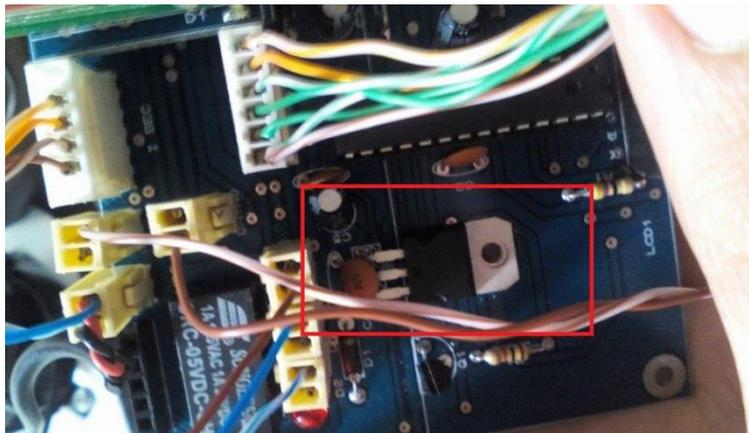
*Figura 40.* Regulador de voltaje LM7805
