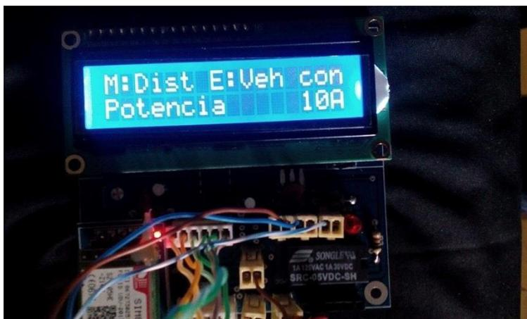
*Figura 53.* Estado vehículo conectado al cargador.
