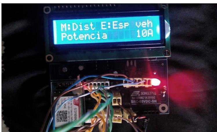
*Figura 55.* Relé activo cortando comunicación entre cargador y vehículo eléctrico.
