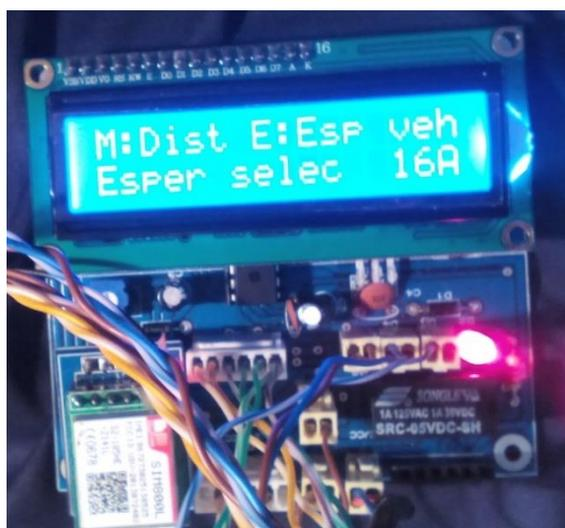
Figura 92. Dispositivo es notificado para el cambio de potencia, se puede realizar la selección por parte de la interfaz gráfica.
