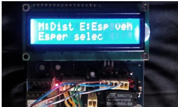
*Figura 51.* Dispositivo en modo distancia, esperando la selección de nueva potencia.
