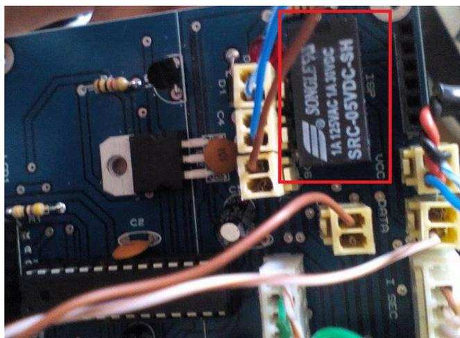
*Figura 47.* Relé para corte de comunicación entre cargador y vehículo eléctrico.
