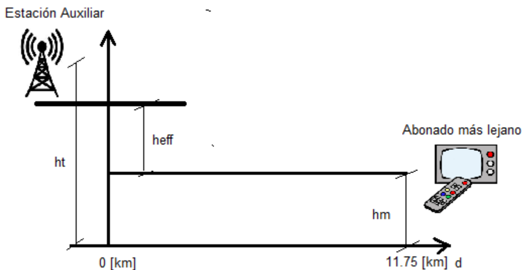
Figura 39. Parámetros para el cálculo de la altura en la antena transmisora
