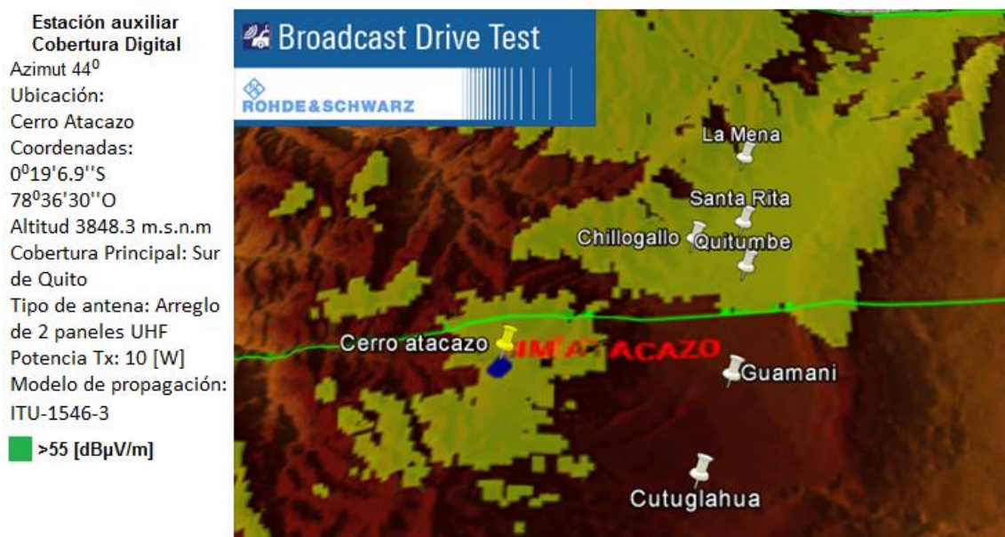
Figura 42. Área de cobertura de la estación auxiliar
