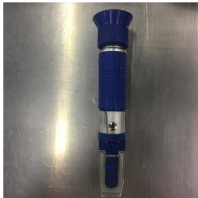
Figura 11. Refractómetro utilizado para medir °Brix.
