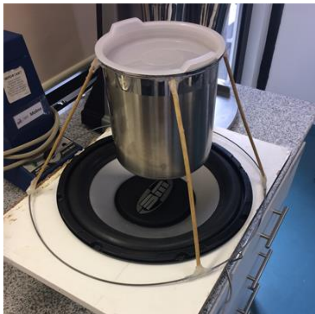
Figura 13. Soporte del prototipo montado con pote.
