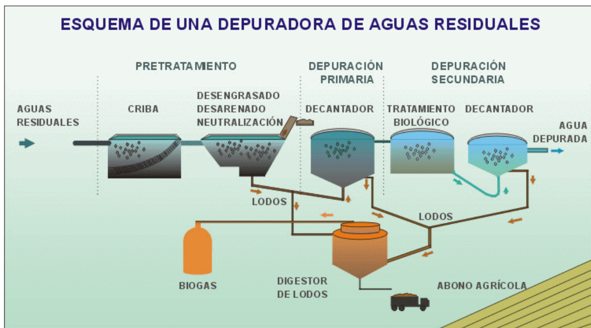
Figura 6. Esquema de tratamiento de aguas residuales.
