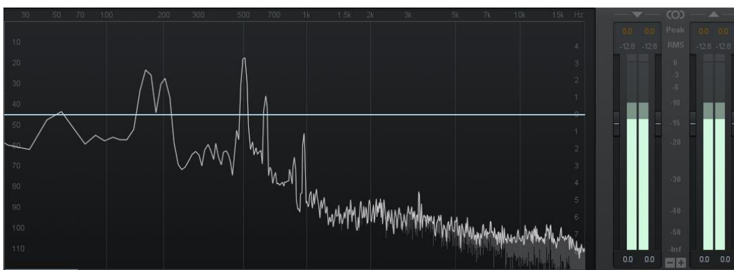
Figura 22. Espectro en frecuencia a 46 minutos en potencia baja.
