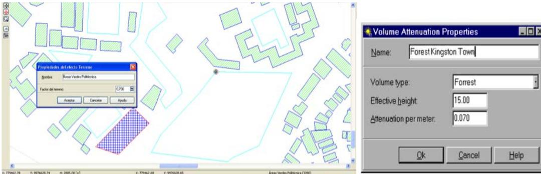
Figura 31. Áreas de atenuación y absorción por volúmen en Soundplan.
