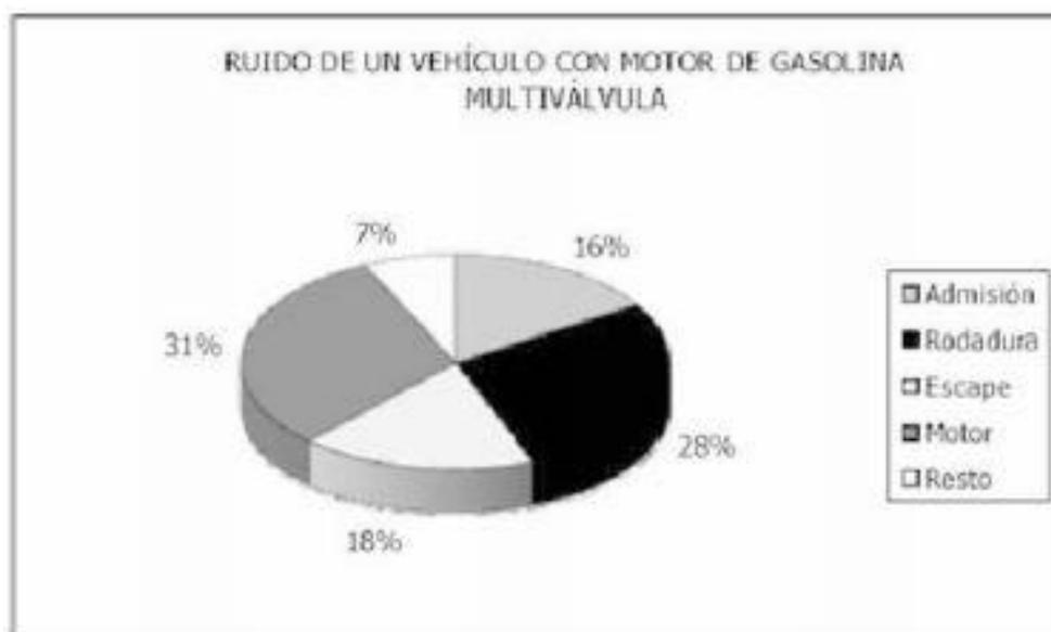
Figura 2. Contribución de las diferentes partes del vehículo al ruido generado
