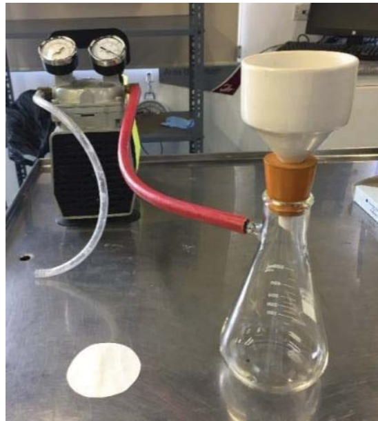
Figura 11. Equipo de filtración ensamblado para el análisis de sólidos suspendidos.
