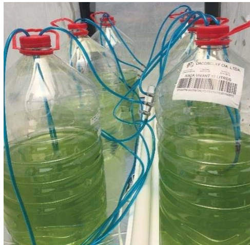
Figura 7. Mangueras para la distribución del gas (CO 2 ) y aire
