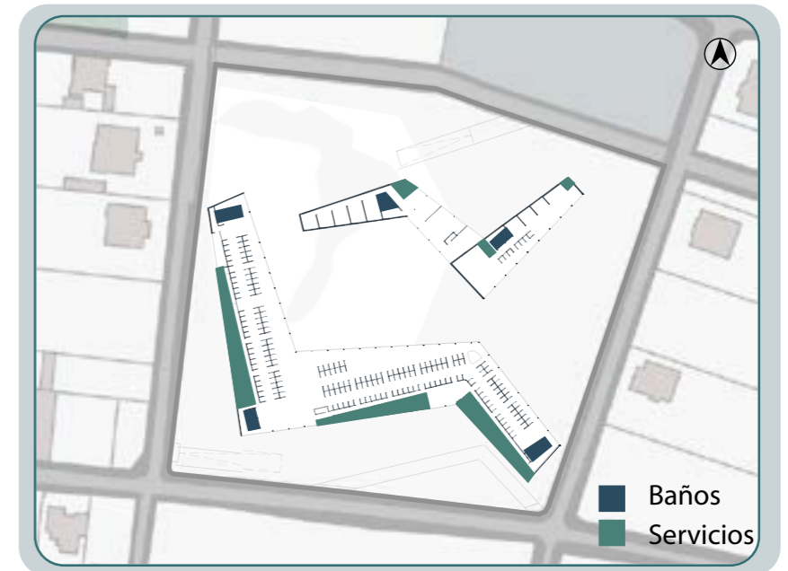
Figura 177: Diagrama D. Propuesta - E. Servidos/ E. Servidores. Se agrupan las áreas de servicios y se colocan al borde del volumen liberando el resto del espacio para los puestos.
