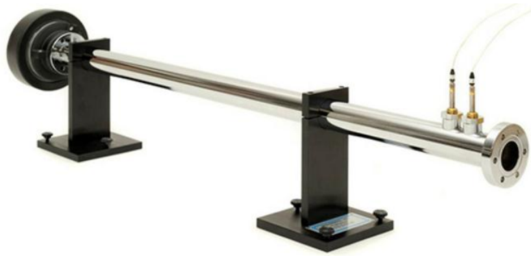
Figura 17. Tubo de impedancia ACUPRO. Tomado de Spectronics, 2016.
