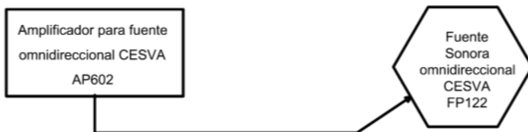
Figura 18. Cadena electroacústica. Diagrama de flujo de señal desde el amplificador CESVA AP602 a la fuente omnidireccional CESVA FP122.
