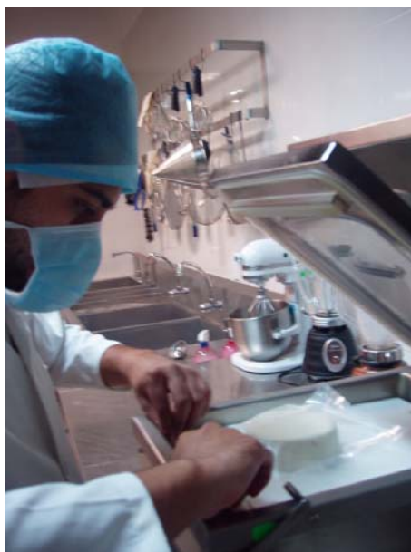
Fotografía 3.40: Empacado al Vacío
