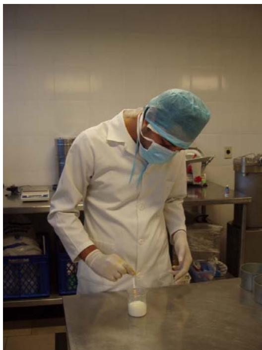
Fotografía 3.23: Medición de pH de la Leche
