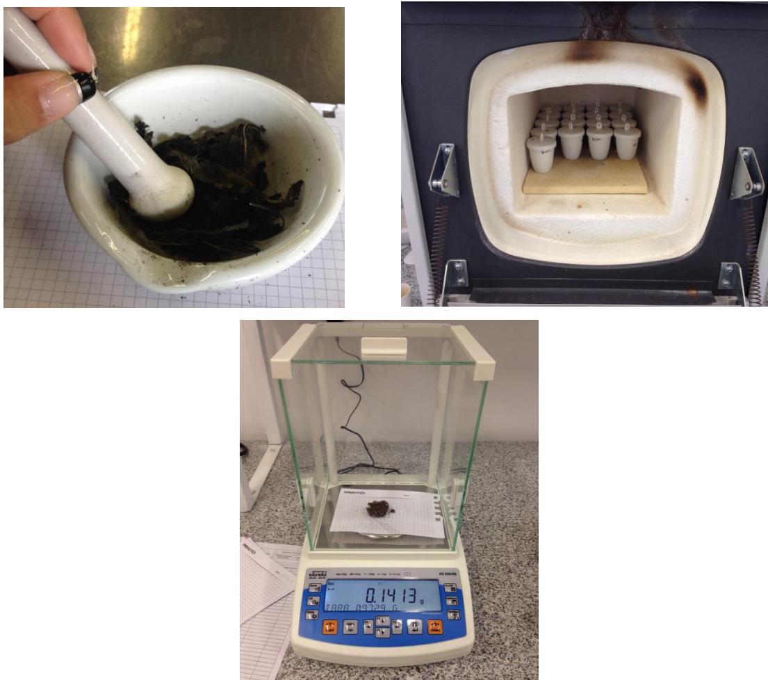
Figura 8. Proceso de trituración para pasar a la mufla y pesaje del peso libre de ceniza
