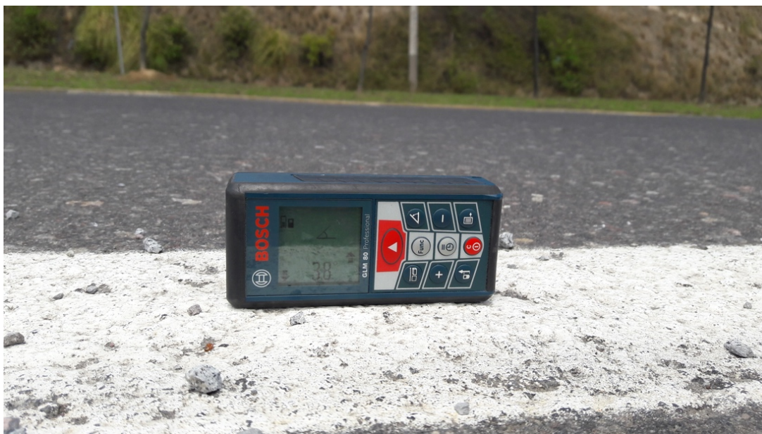
Figura 14. Registro manual de pendiente con el equipo GLM80 BOSH.
