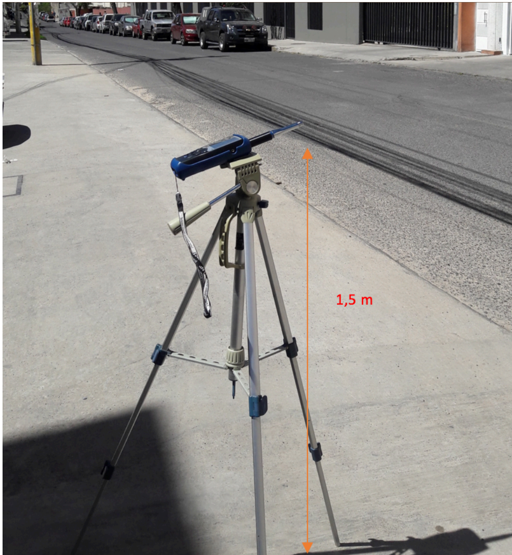
Figura 18. Ubicación del sonómetro NTi durante un registro de ruido vehicular.
