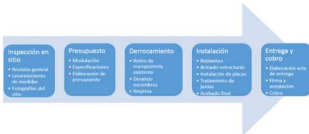
*Figura 20.* Diagrama de flujo del proceso de reparación de viviendas
