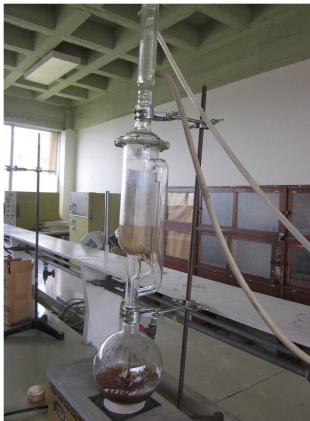
Figura 26 Producto de la extracción Soxhlet Elaborado por: La autora
