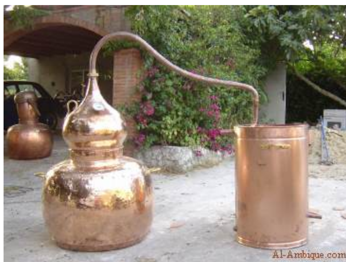
Figura 28 Alambique de cobre 500L Tomado de: al-ambike, 2012.
