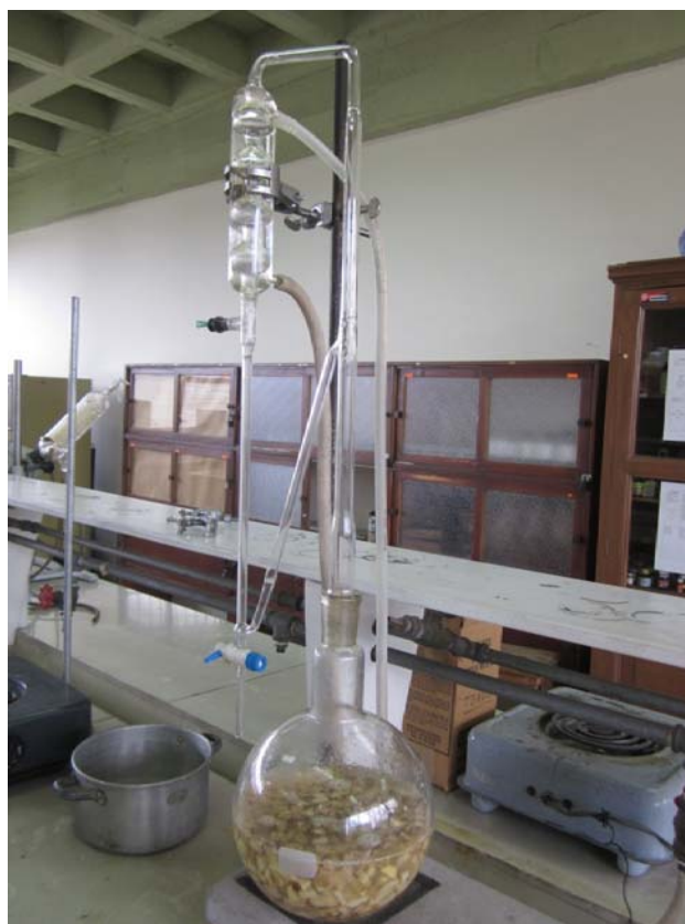
Figura 22 Equipo “Clavenger” para Hidrodestilación Elaborado por: La autora
