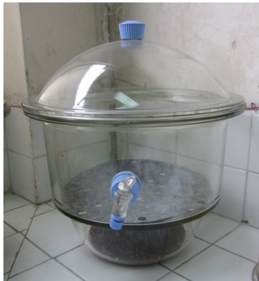
Figura 18 Desecador con desecante en la parte inferior del equipo Elaborado por: La autora
