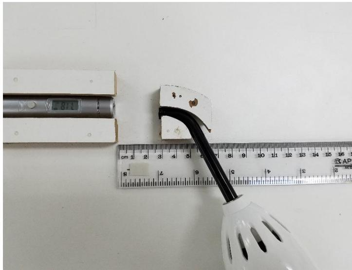
*Imagen 5. Lámpara #22 Toma de Temperatura con Termómetro Digital a 3 cm
