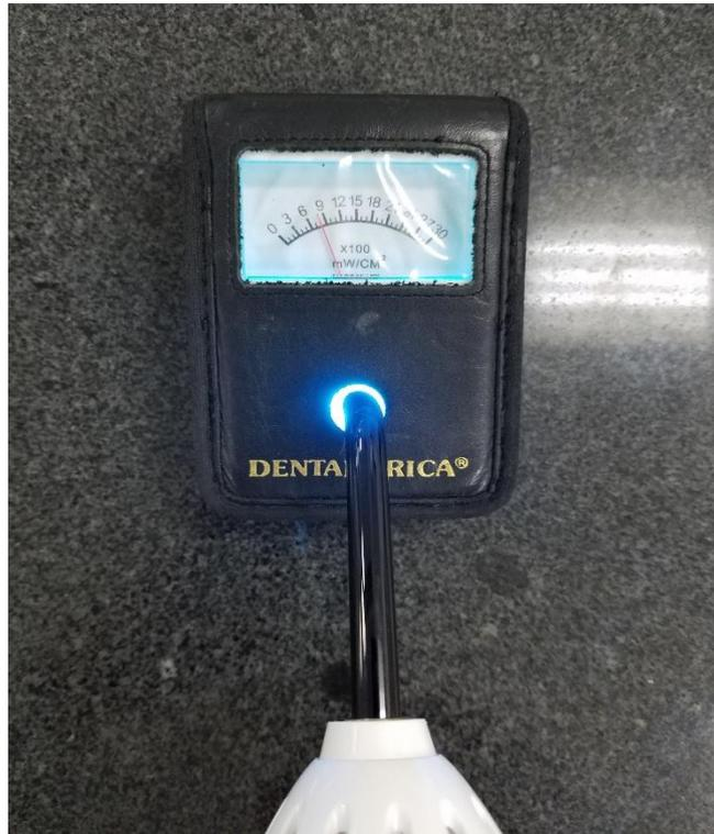
Imagen 7. Lámpara #22. Medición de la Intensidad de Luz con Radiómetro
