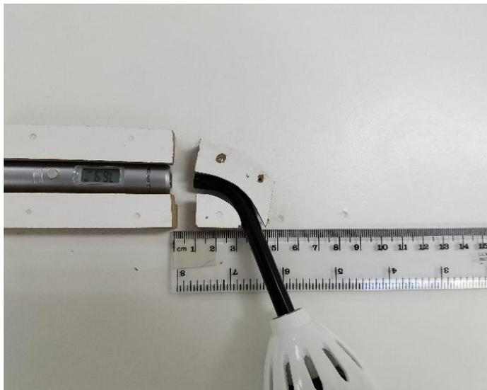
Imagen 1. Lámpara #22 Toma de Temperatura con Termómetro Digital a 1cm
