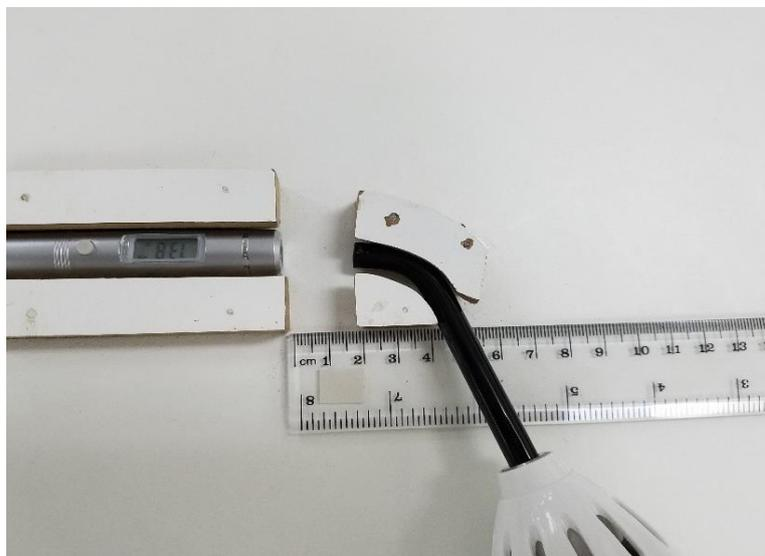
*Imagen 3 Lámpara # 22. Toma de Temperatura con Termómetro Digital a 2 cm
