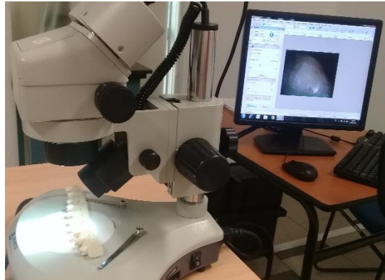
Figura 20: Observación en el estereomicroscopio de ESI- final de la muestra, posterior al pulido
