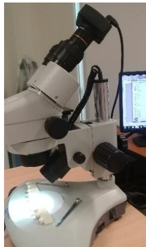
Figura 16: Evaluación del ARI mediante estereomicroscopio y registro fotográfico
