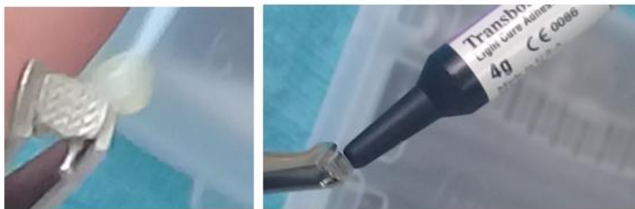
Figura 10: Colocación de bonding en cada espécimen y resina Transbond XT en cada bracket
