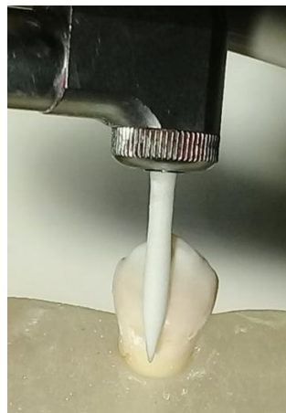
Figura 19: Pulido de la muestra con fresa de fibra de vidrio Fiberglass TDV en pieza de baja velocidad
