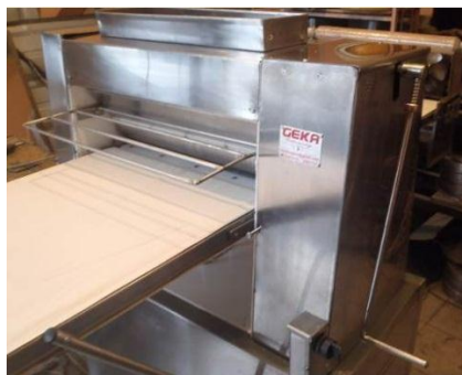
Figura 46. Laminadora industrial doble rodillo Tomado de GEKA, 2012.
