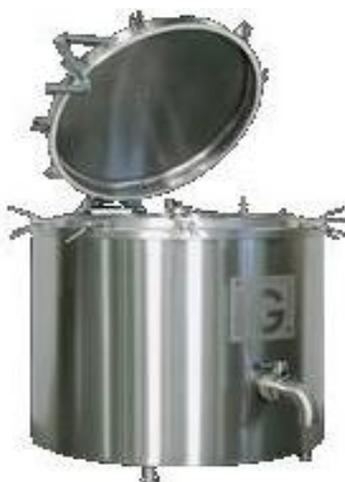
**Extractora:** Extractor de jugos de uso fácil y rápido para producir hasta 40 litros (jugo de zanahoria fresca), con diseño ergonómico, sirve para frutas y verduras de diferentes tipos. A diferencia de otras marcas, este extractor disminuye el desperdicio que en forma natural acompaña el bagazo hasta un 90% y que permiten tener mejores utilidades. Capacidad de producción: 80-100 Kgs/Hr
