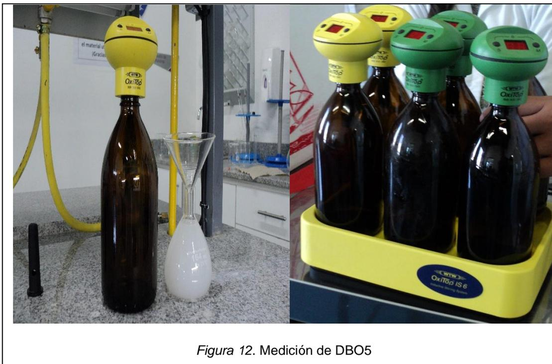
Figura 12. Medición de DBO5
